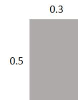
La altura de la sección de viga considera el espesor de losa entre piso y techo. El espaciamiento de los estribos será de acuerdo a lo indicado en el plano respectivo, y el concreto será de  $f'c = 210 \text{ Kg/cm}^2$ .
