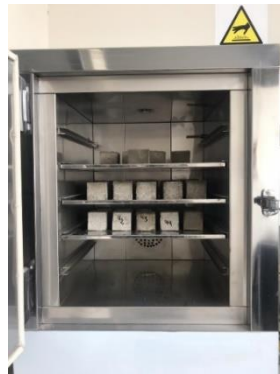
Figura 17. Curado de los morteros en el horno tipo mufla.
