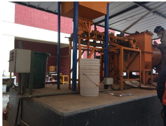
Figura 15. Molienda del mineral rico en oxido de baja ley
