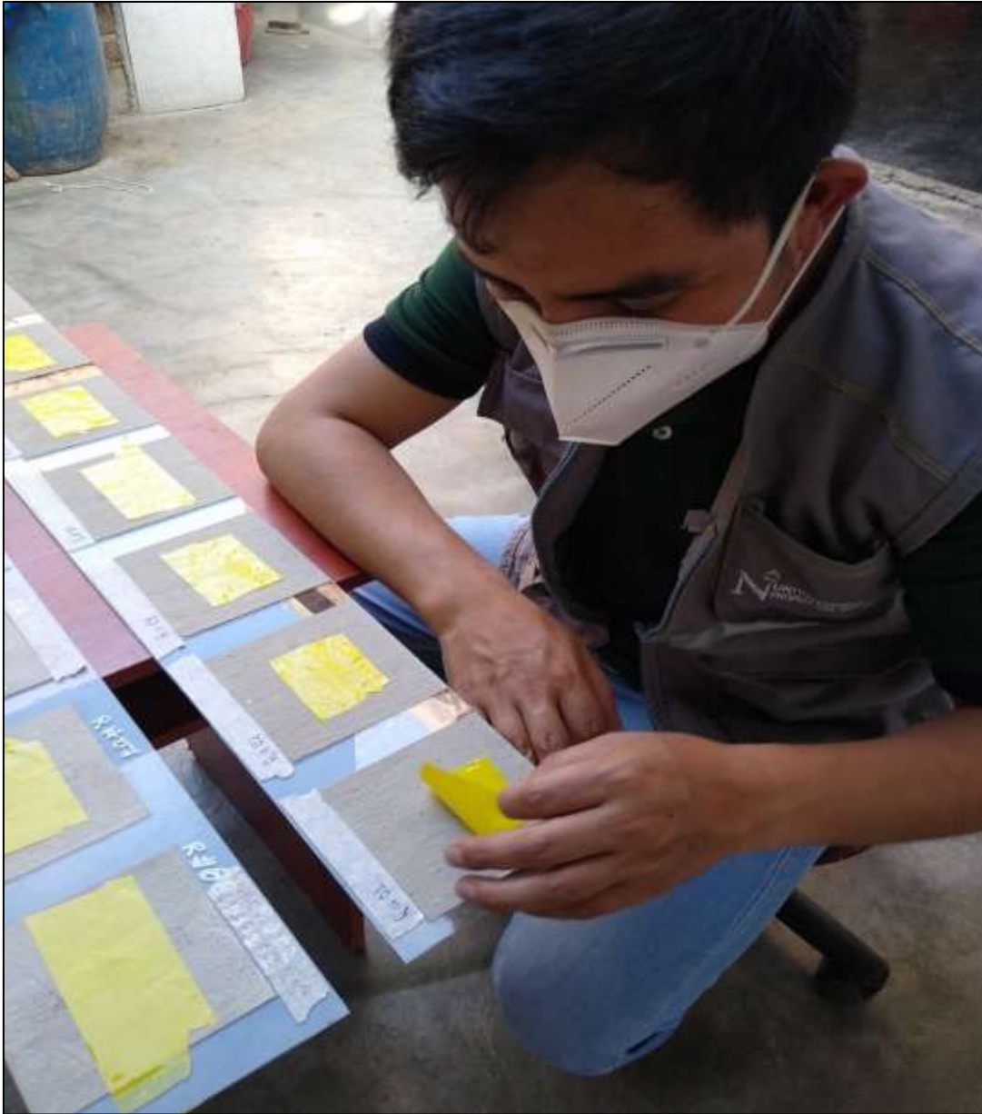
ANEXO 94: Realización de ensayo de adherencia.
