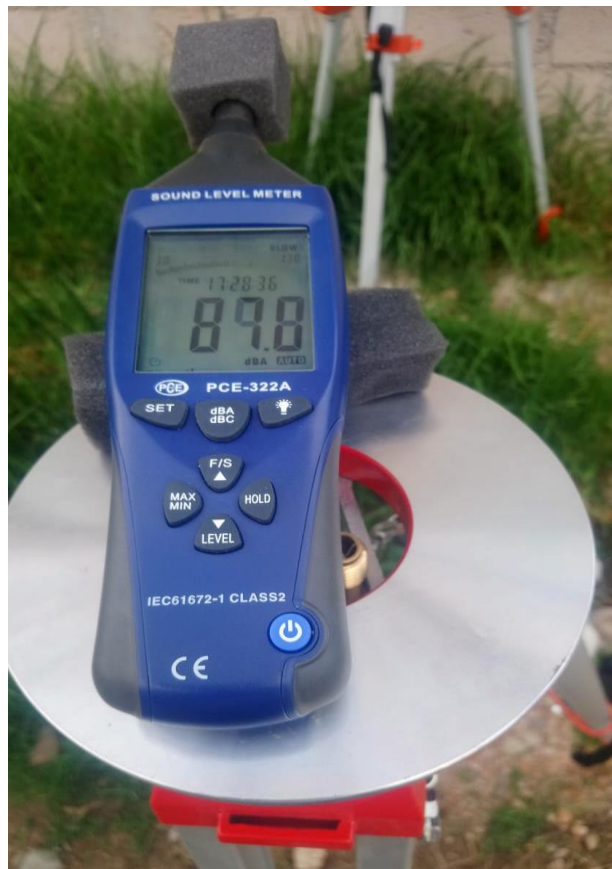
Figura 11 Medición del nivel de ruido en el exterior de vivienda
