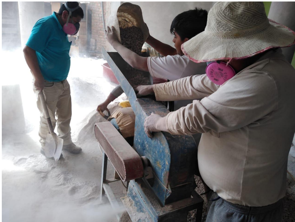
Figura 3 Trituración de la arcilla
