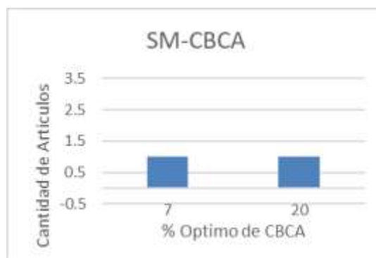
Figura 16: % óptimo de CBCA para suelos SM
