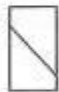
Tipo 4 Fissura diagonal sin fisuras a través de los extremos, pérfila suavemente con un método para distinguirla del Tipo 1
