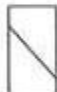
Tipo 4 Fractura diagonal sin fisuras a través de los extremos; golpe suavemente con un martillo para distinguir del Tipo 1.
