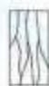
Tipo 3 Fisuras verticales encorvadas a través de ambos extremos, pero no bien formado
