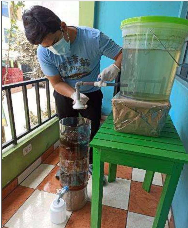
“Tratamiento a nivel piloto de aguas residuales de la Asociación San Pedro de Choque del distrito Puente Piedra mediante el diseño e instalación de un biofiltro”
