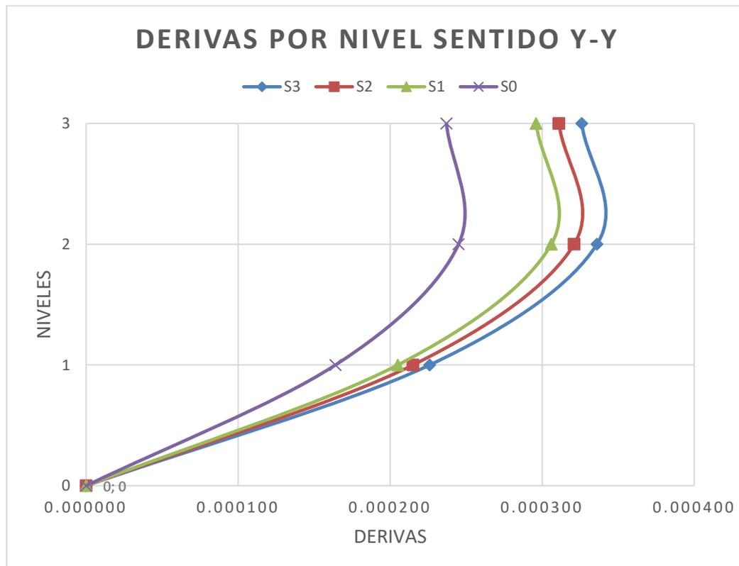
Al igual que en el sentido Y el cálculo de las derivas se ha determinado que las derivas cumplen la norma técnica peruana E030 con la cual tenemos un máximo menor que el 0.007, dando una confiabilidad de los resultados finales del diseño y la respuesta estructural del modelado.
