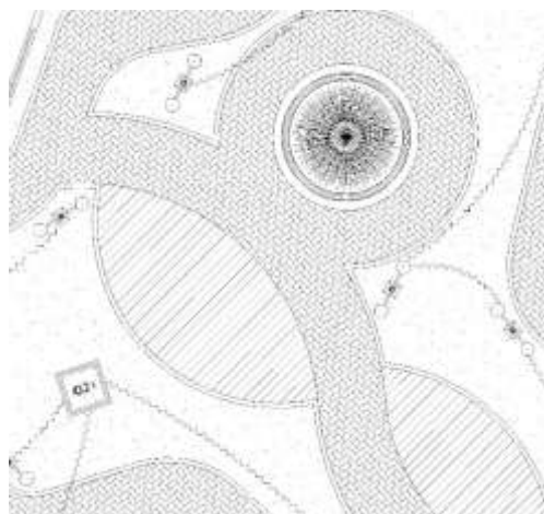
Figura 32: Circuito de alumbrado exterior
