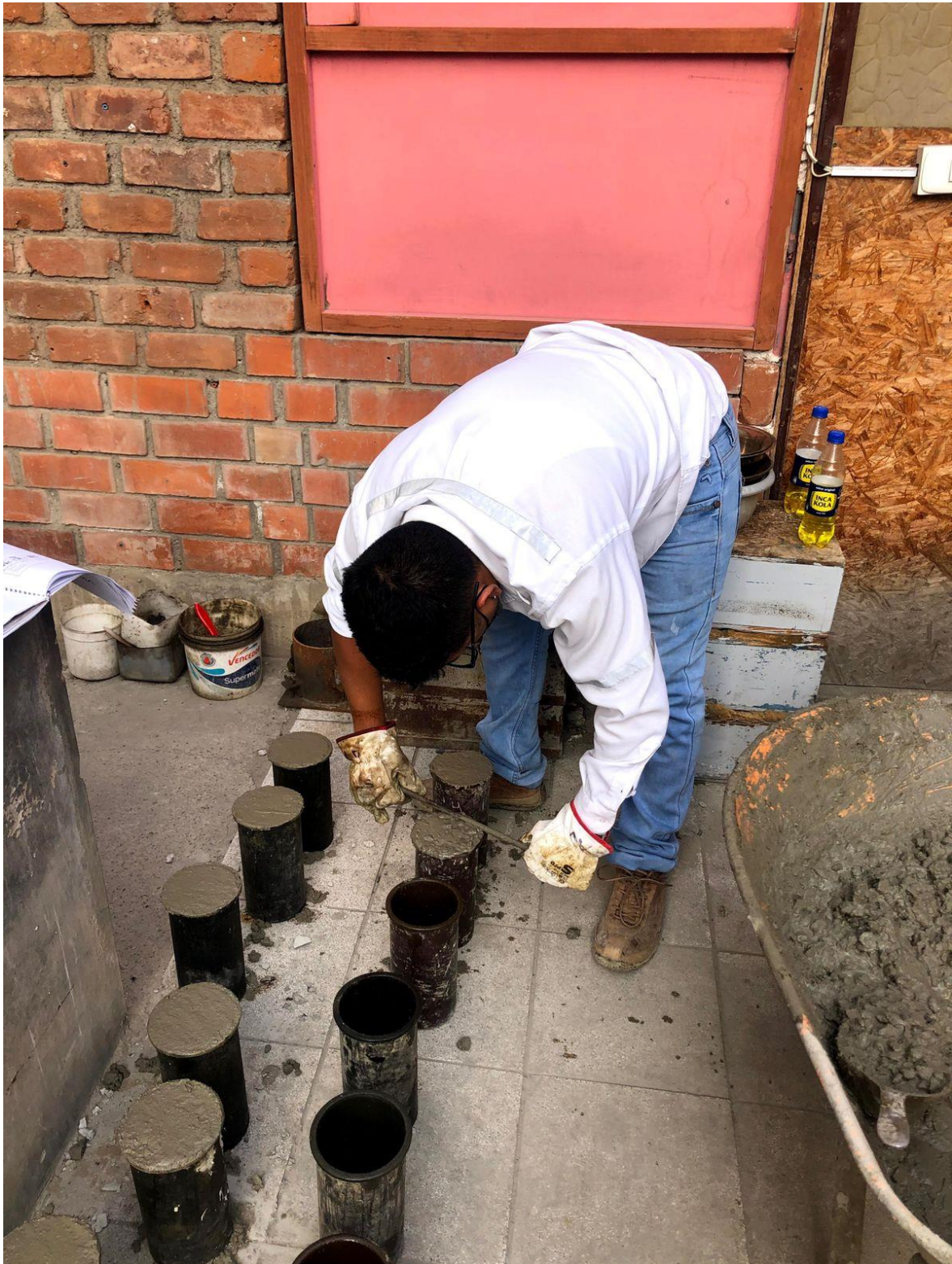
Figura 15. Enrazado de probetas para su posterior curado
