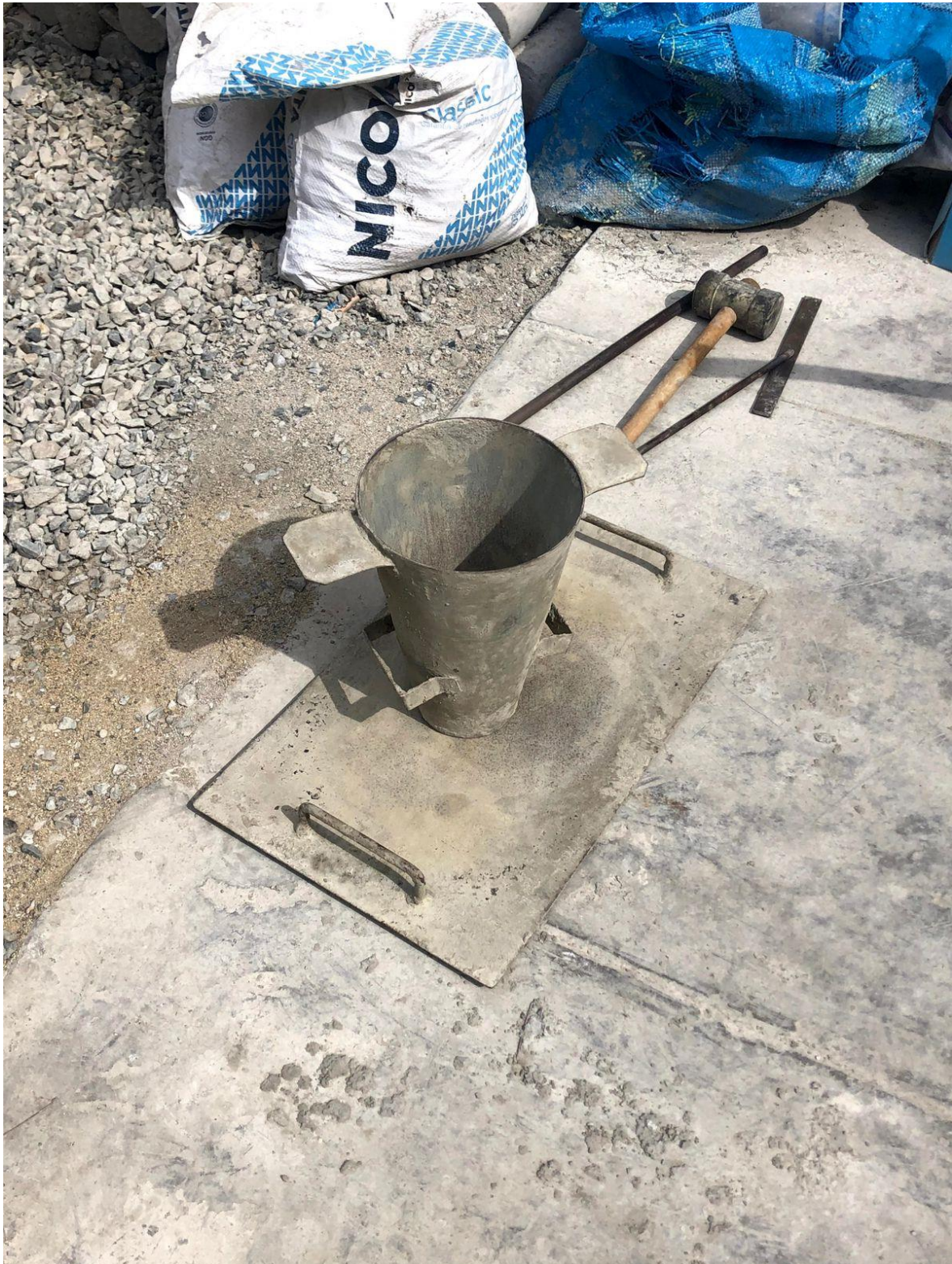
Figura 10. Cono de Abrams para obtener el Slump del concreto
