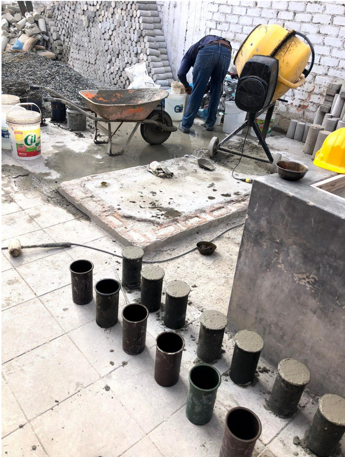
Figura 11. Probetas cilíndricas llenas de concreto
