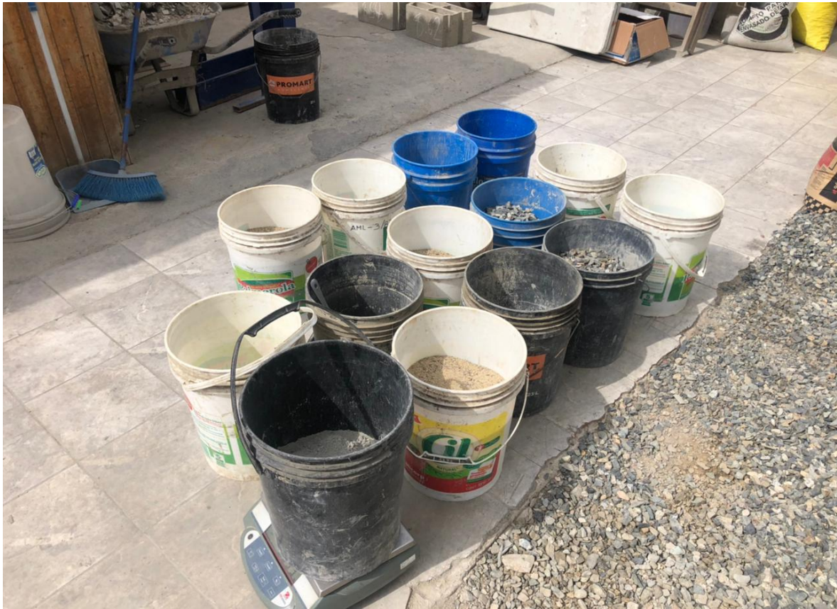
Figura 9. Proporción de materiales para tandas de concreto según diseño
