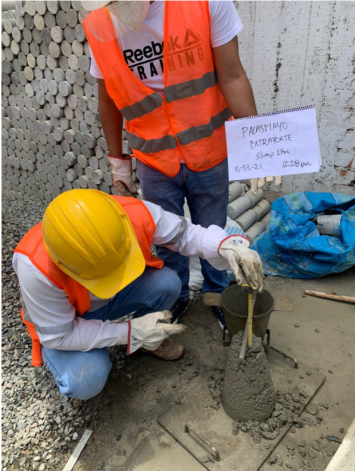
Figura 14. Verificación de slump del concreto elaborado con cemento Pacasmayo Extraforte
