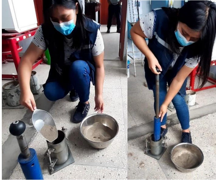
Figura 18 Realización del ensayo de Proctor modificado del suelo
