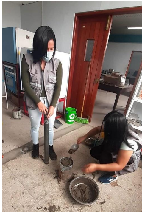
Figura 20 Compactación de la muestra para el ensayo CBR
