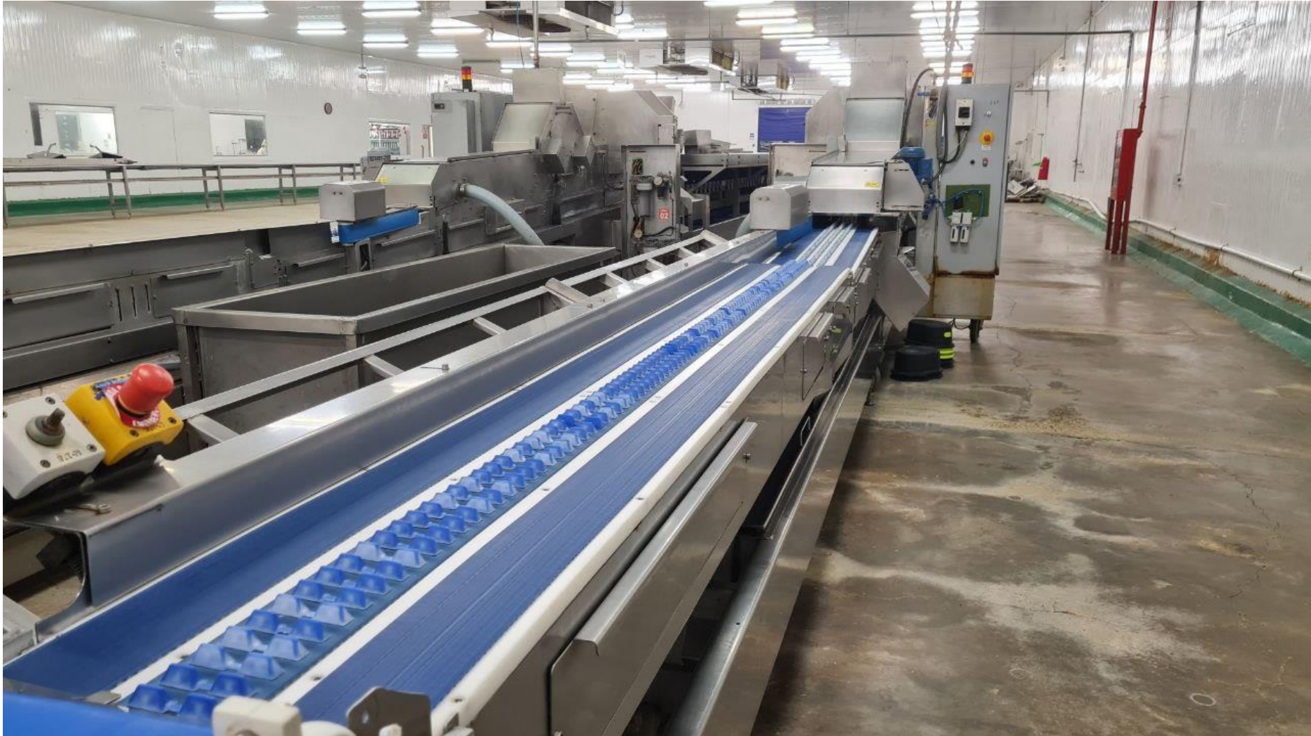
Anexo 03: Foto de la sección de acomodo u ordenamiento de la máquina clasificadora
