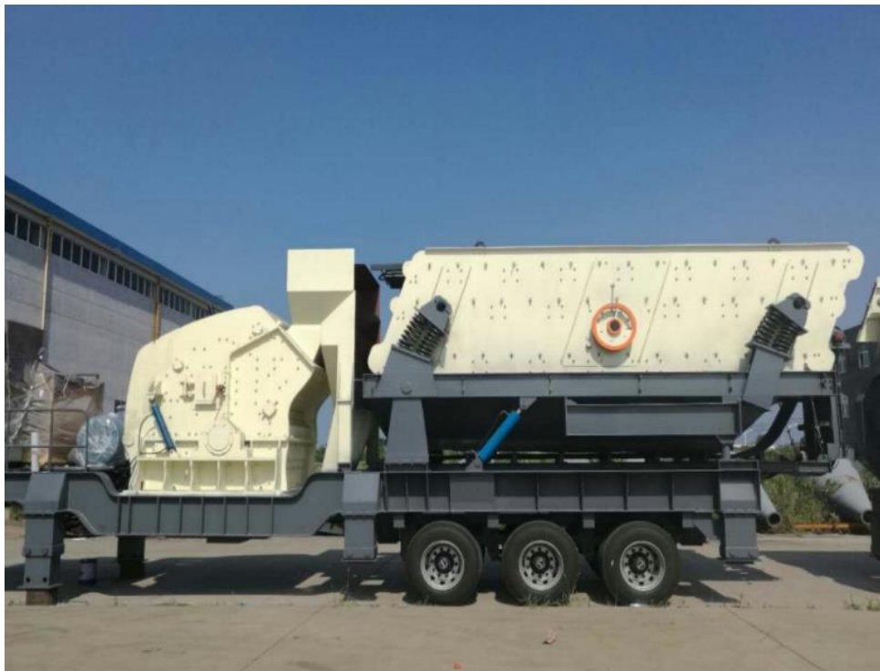
Figura 21: Planta Chancadora parte lateral
