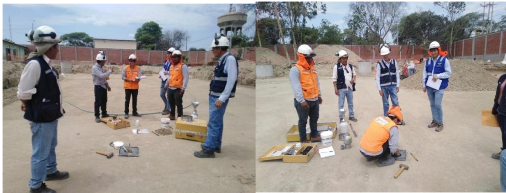
Figura 68: Prueba de densidad de campo en el relleno con material de préstamo
