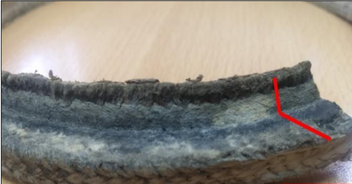
Figura 2: Desgaste de estopa al cumplir las 720 horas.
