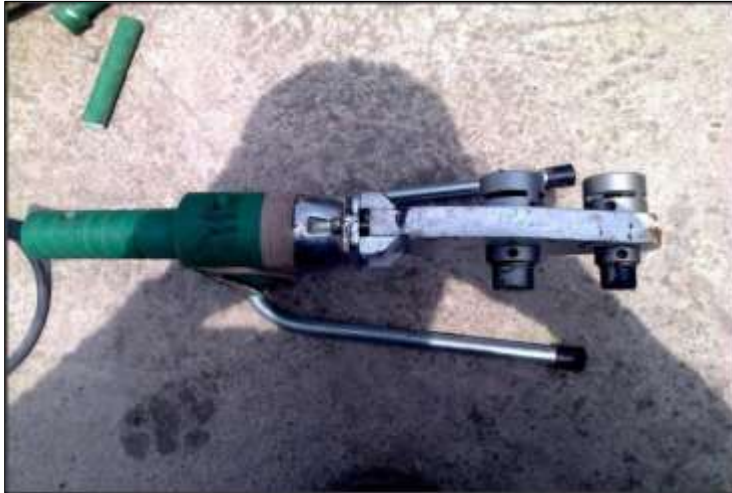
Figura 47: Uso de Termofusora.
