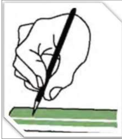
Figura 32: Marcado de la Tubería de Polipropileno
