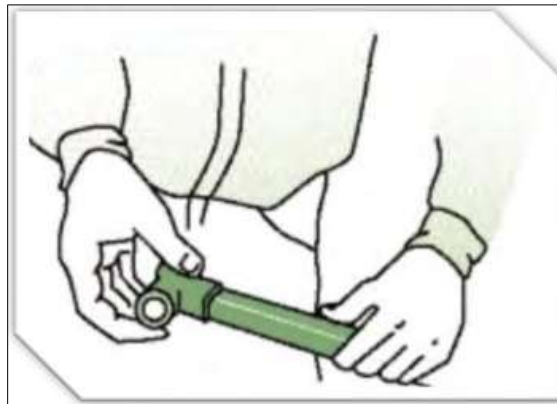
Figura 36: Ajustar a Conexión Durante 3 Segundos.
