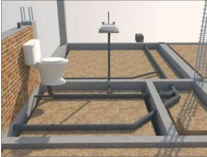
Figura 57: Instalaciones de Desagüe.
