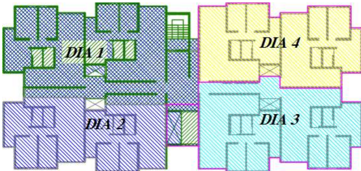
Figura 45: Sectorización de Instalaciones Sanitarias.
