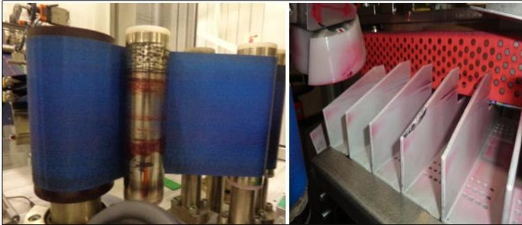
*Figura 39.* Conveyor y pockets antes de la limpieza e inspección.
