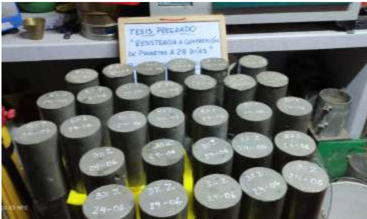
Figura 22: Probetas con Microsílíce Z listas para ensayo Fuente: Fotografía Propia tomada en Laboratorio de Mecánica de Suelos A & J.
