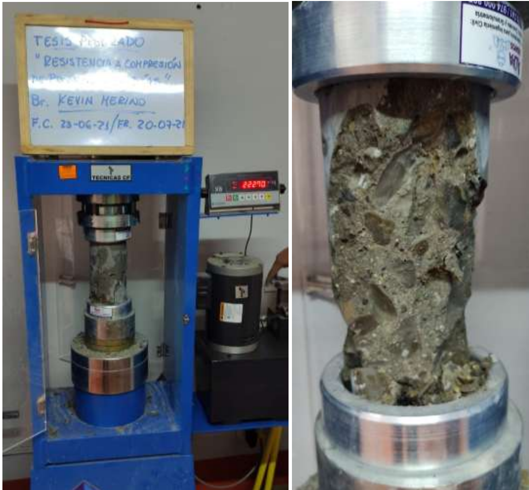
Figura 23: Ensayos de resistencia a Probetas Patrón // Figura 24: Fallo de probeta patrón
