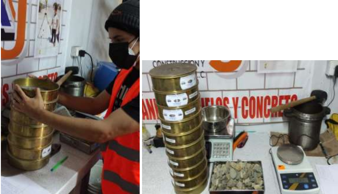
Figura 10: Tamizado de agregados // Figura 11: Herramientas para caracterización de agregados
