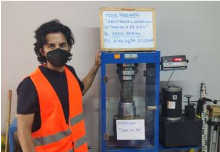
Figura 25: Ensayos de resistencia a Probetas con Sika Fume
