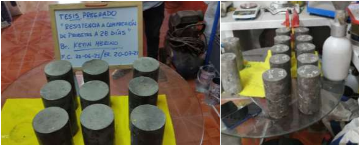
Figura 20: Probetas Patrón a los 28 días // Figura 21: Probetas con Sika Fume 9% listas para ensayo Fuente: Fotografía Propia tomada en Laboratorio de Mecánica de Suelos A & J.
