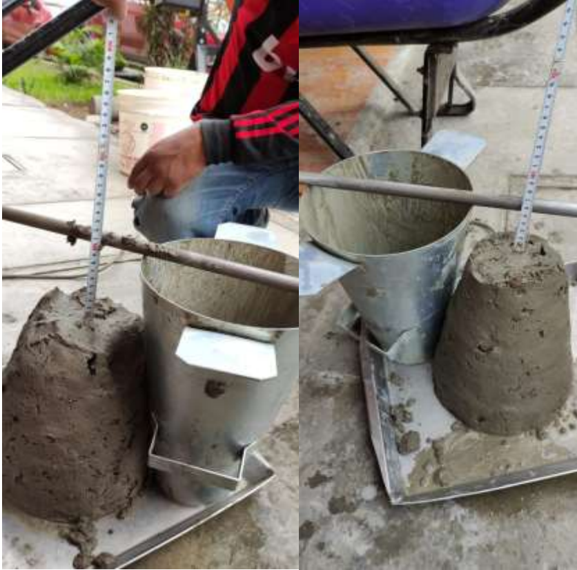
Figura 18 y 19: Ensayos de asentamiento
