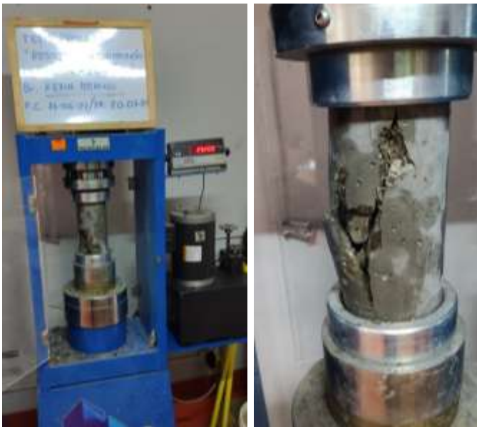
Figura 26 y 27: Ensayos de resistencia a Probetas con Microsílíce Z
