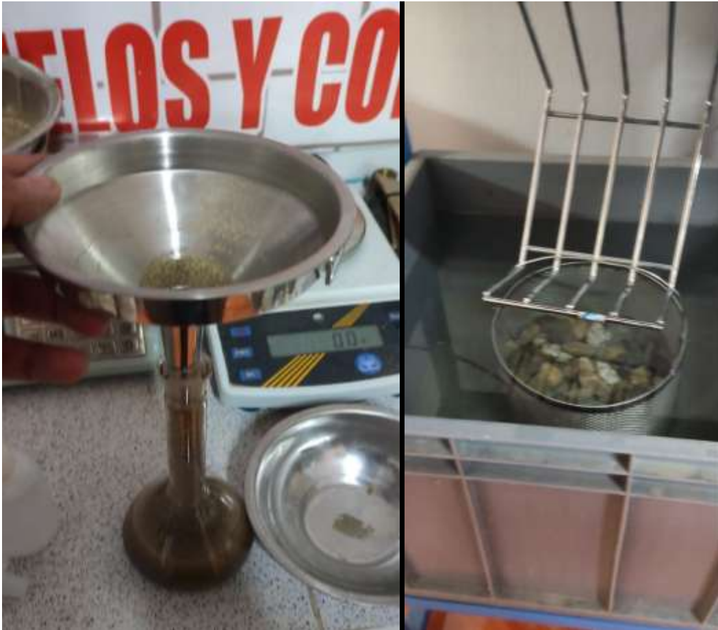
Figura 12: Ensayo de densidad // Figura 13: Ensayo de absorción
