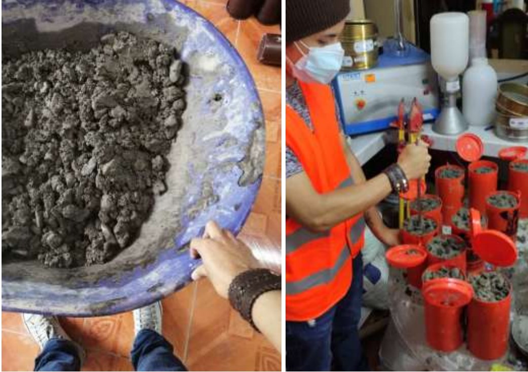
Figura 16: Realización de la mezcla // Figura 17: Chuzado y llenado de las probetas
