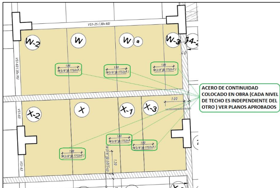
Figura 27. Detalle de acero de continuidad. Fuente: Entrepisos.
