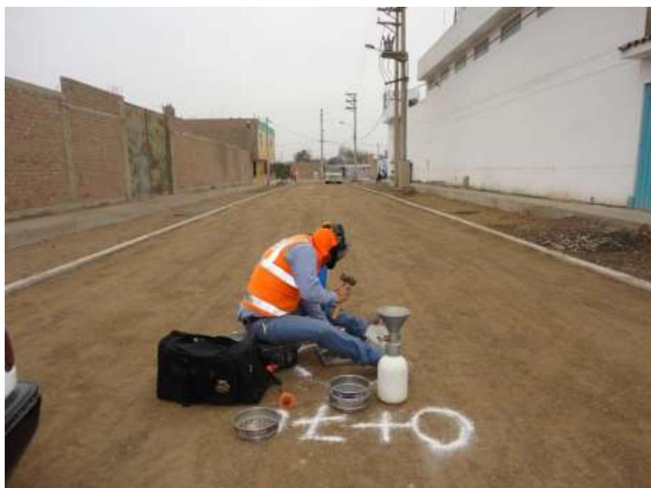
Figura 28 Se verificó los ensayos de densidad in-situ en base de pavimento en la calle 08.
