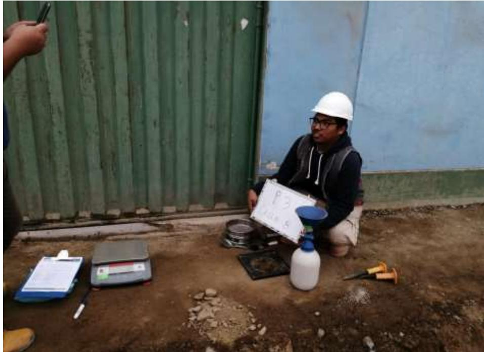
*Figura 13 Se verifica ensayos de densidad in situ en base de vereda.*
