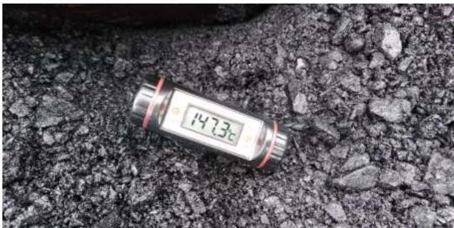
*Figura 42 Se verificó la temperatura del asfalto.*
