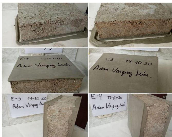
Figura 41. Refrendado de especímenes E-3 y E-4. Fuente: Elaboración propia.
