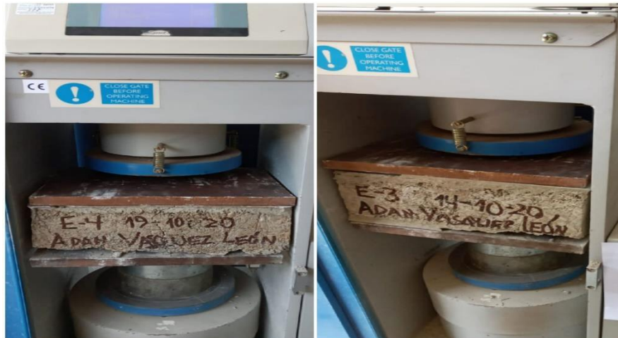
Figura 43. Especímenes E-3 y E -4 posterior al ensayo de compresión.
