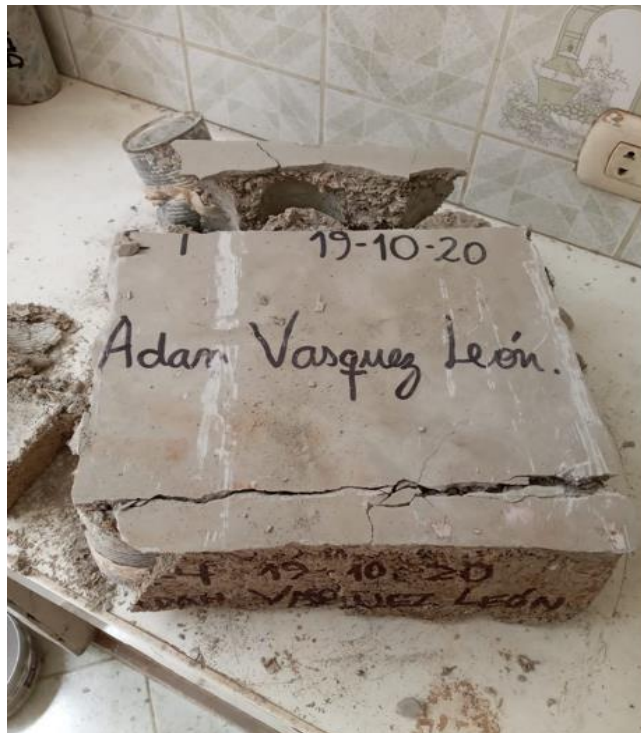
Figura 12. Especimen 4 posterior a ensayo de compresión. Fuente propia.
