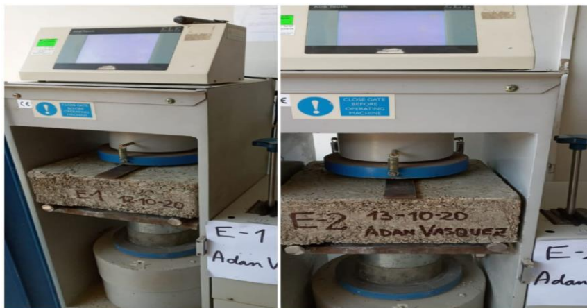
Figura 38. Especímenes E-1 y E - 2 antes de ensayo de módulo de rotura (flexión). Fuente: Elaboración propia.
