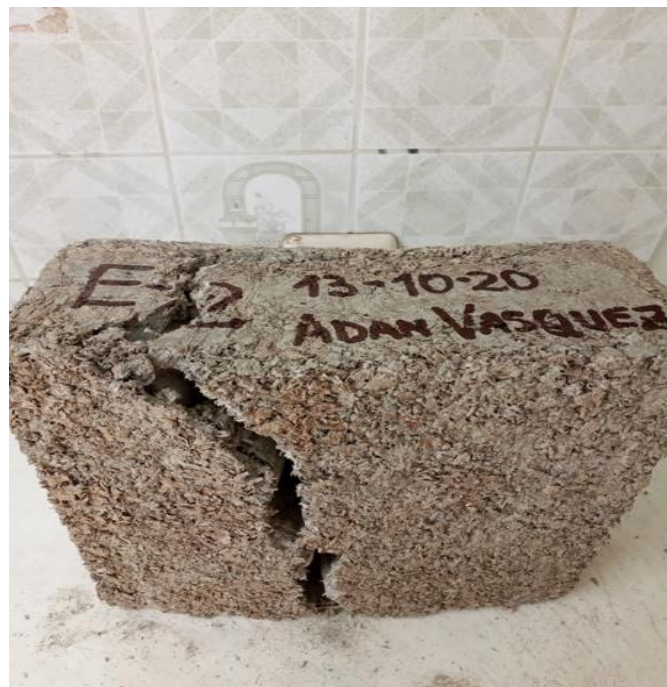
Figura 14. Espécimen 2 posterior a ensayo de flexo – tracción. Fuente propia.
