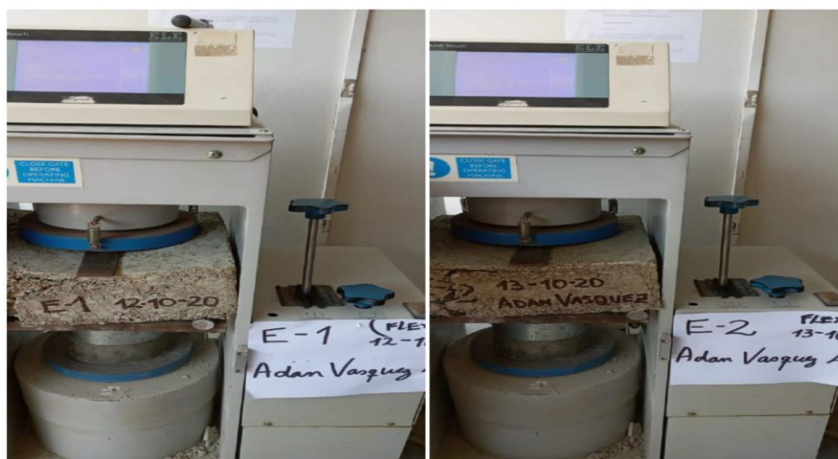
Figura 39. Especímenes E-1 y E-2 posterior a ensayo de módulo de rotura (flexión). Fuente: Elaboración propia.
