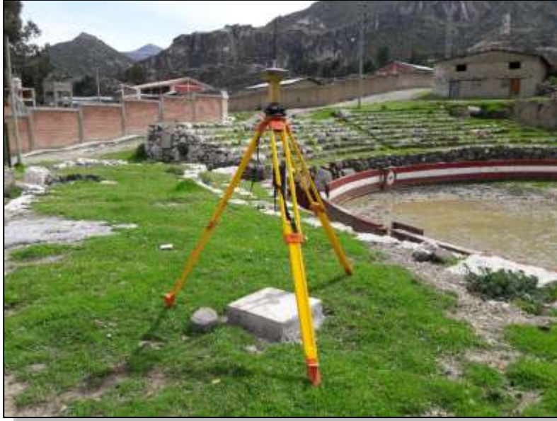
Figura 22: Nivelación Geométrica desde el BM = GPS-4
