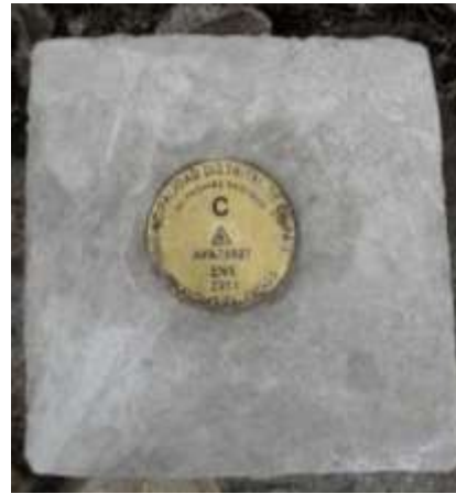
Figura 17: Placas de puntos geodésicos
