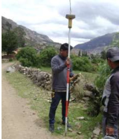
Figura 40: Levantamiento topográfico con GPS diferencial de los puntos Foto Control
