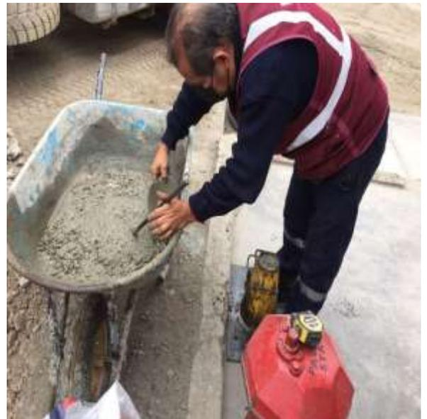
*Figura 71:* Vaciado de concreto, para prueba de cono de abrams.
