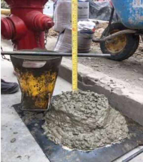
*Figura 72:* Medición del asentamiento del concreto (slump), para comprobar la trabajabilidad del concreto.
