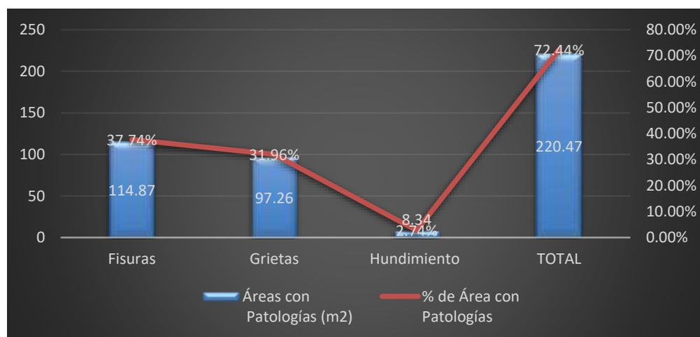
*Figura 30: Porcentaje de patologías estructurales presentes y áreas en m<sup>2</sup> afectadas en el piso de concreto.*
