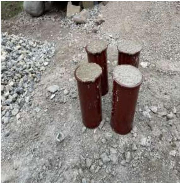
*Figura 70:* Vaciado de concreto en probetas, para realizar ensayos de resistencia a la compresión de concreto.
