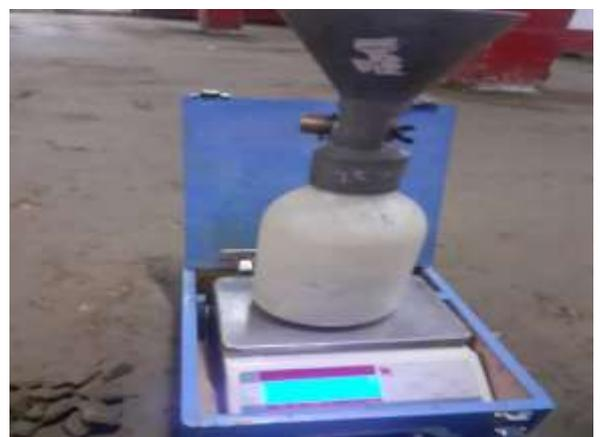
*Figura 55:* Peso de arena contenida en recipiente, para determinación del volumen.
