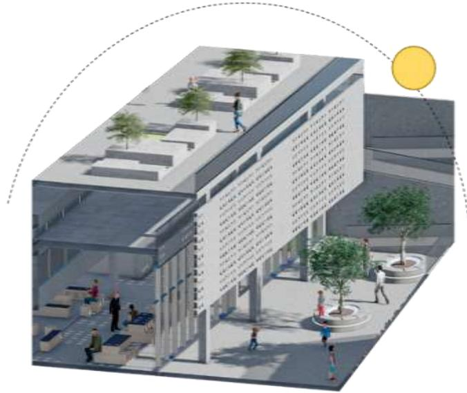
*Figura 4.50.* Comportamiento solar: vista B, 3:00 p.m. Comportamiento solar en el bloque del centro comunitario, Diciembre 3:00 p.m. El sol se ubica hacia el lado oeste chocando con los paneles perforado, protegiendo del ingreso directo de luz solar por la fachada de ese lado.
