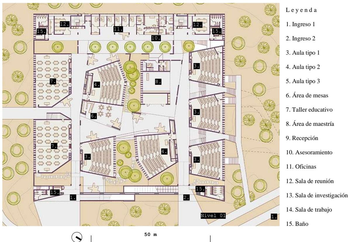
Figura 3.1. Planta del aulario UDEP, Nivel 0. (Red fundamentos, 2017)
