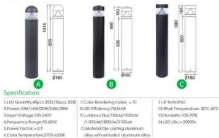
Figura 4.120. Luminaria para exteriores. Luminaria de poste para exterior modelo BOLLARD DLW – LED – 028 marca fukupark (fukupark S.f.).
