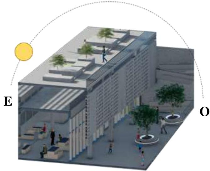
*Figura 4.48.* Comportamiento solar: vista B, 8:00 a.m. Comportamiento solar en el bloque del centro comunitario, Diciembre 8:00 a.m. Este bloque es subterráneo, se regula la temperatura absorbiendo energía calórica mediante xeropaisajismo en el techo.
