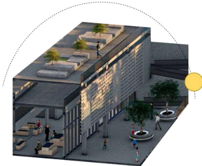
*Figura 4.51.* Comportamiento solar: vista B, 6:00 p.m. Comportamiento solar en el bloque del centro comunitario, Diciembre 6:00 p.m. El sol se va ocultando e ingresa tenuemente a los espacios a través de los paneles perforados. Elaboración propia.
