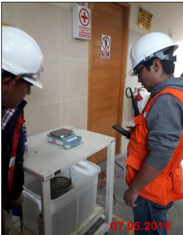
**Gráfico N° 17** *Ensayos realizados - Peso específico del agregado fino*
