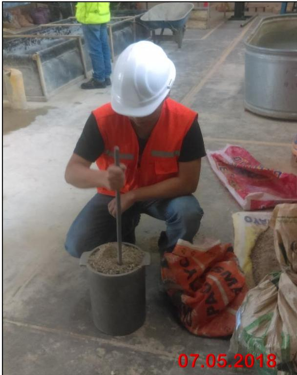
**Gráfico N° 16** *Ensayos realizados - Peso específico del agregado grueso*
