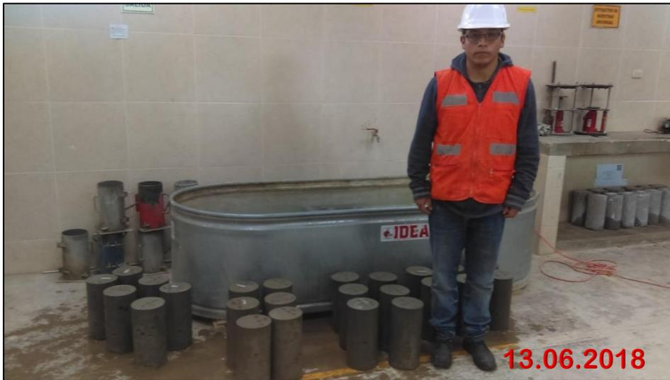
**Gráfico N° 20** *Ensayos realizados – Ruptura a la compresión de especímenes de concreto*
