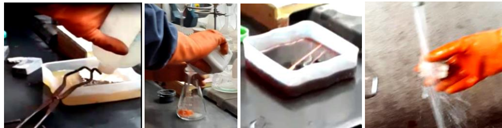
Figura N° 16: Procedimientos de la tinción de feldespatos potásicos.
