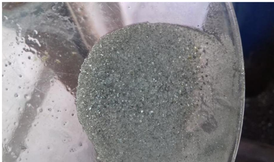
Figura N° 26: Plateo del relave, se aprecia poca presencia de pirita color amarillo pálido, cuarzos y calizas. no se aprecia mineral sulfuro plata plomo antimonio.
