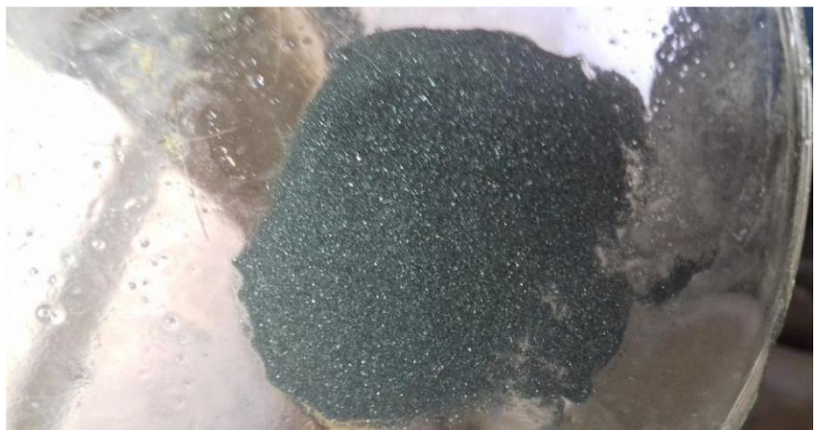
Figura N° 24: Plateo del concentrado de plomo plata, se aprecia la estibina color plomizo opaco y lamas negras con alto contenido de plata.
