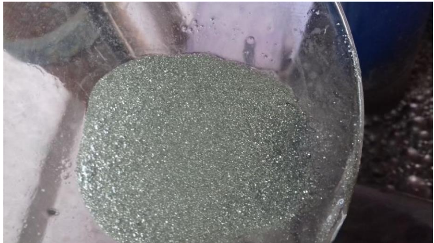
Figura N° 25: Plateo del concentrado de pirita.
