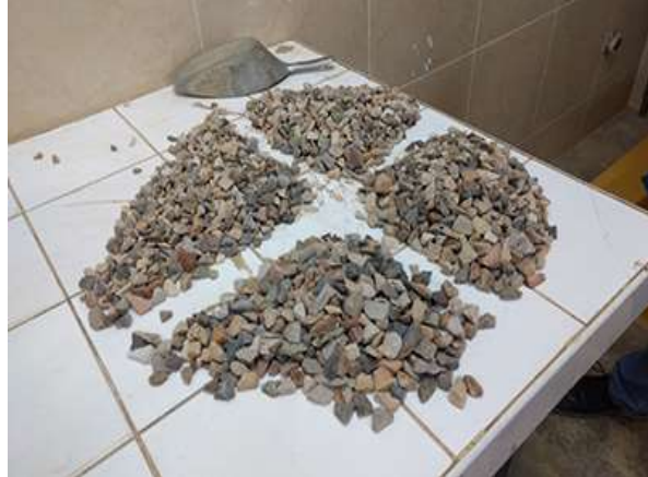
Fotografía N° 2. Método de cuarteo del agregado grueso.
