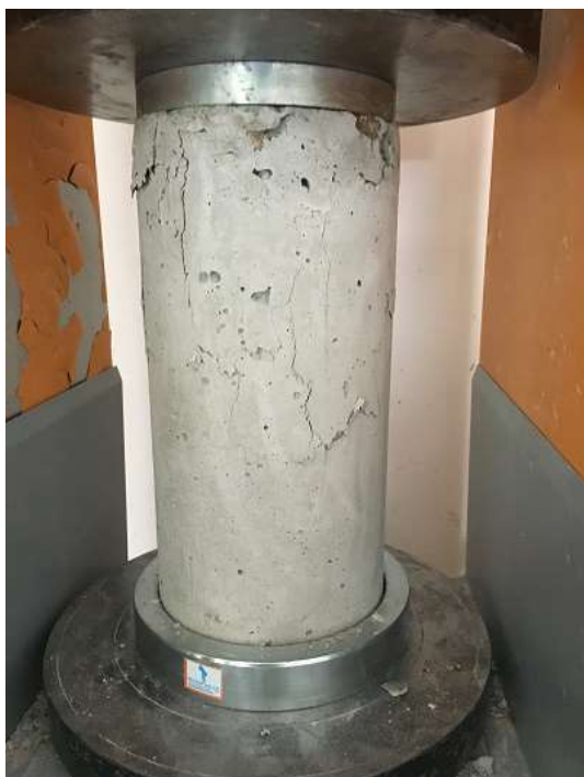
Fotografía N° 21. Falla tipo 3 de acuerdo con la Norma Técnica Peruana 339.034
