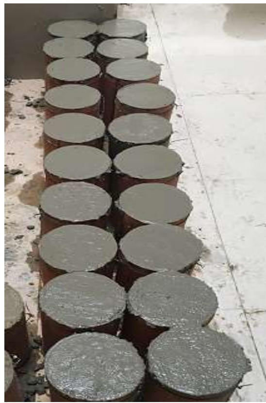
Fotografía N° 12. Elaboración de probetas.
