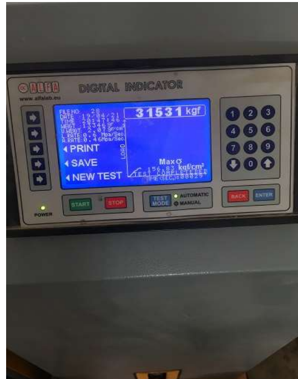
Fotografía N° 20. Carga ultima, luego de realizar el ensayo a compresión.
