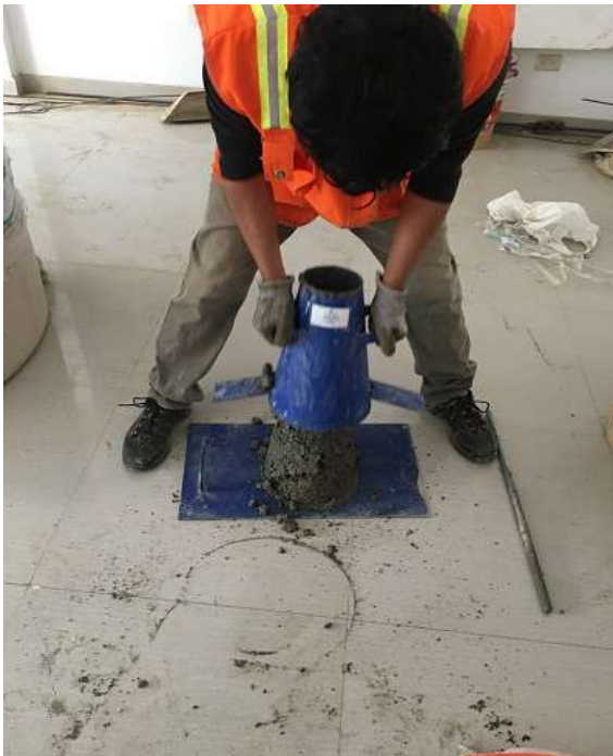
Fotografía N° 7. Prueba del Slump.
