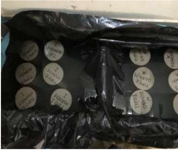
Fotografía N° 13. Curado de probetas de concreto
