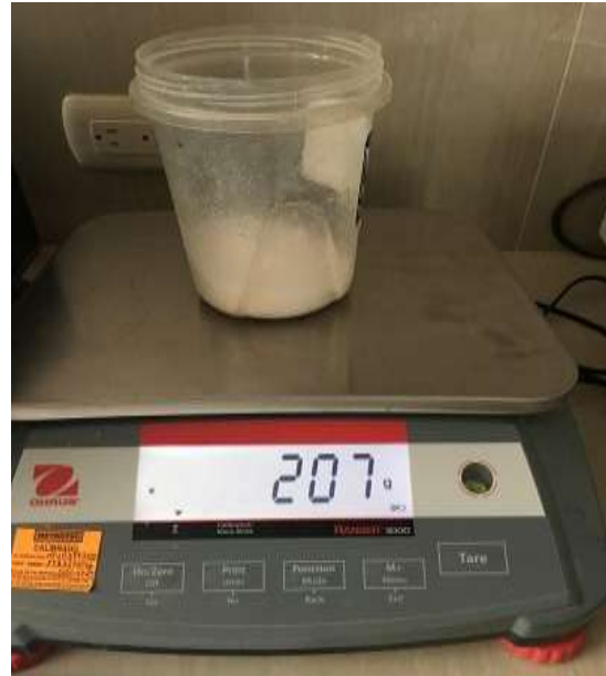
Fotografía N° 16. Pesando el Sulfato de Magnesio.
