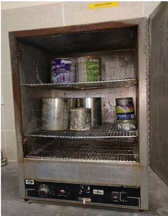
Fotografía N° 3. Secado en horno para sacar el contenido de humedad de los agregados de cerro.
