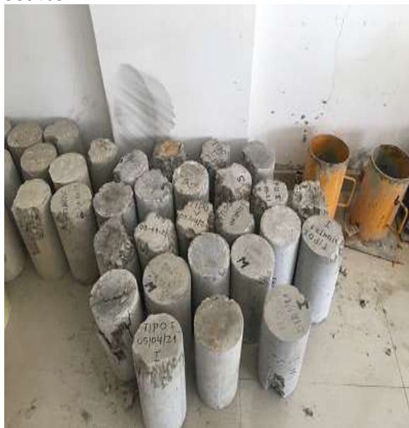
Fotografía N° 24. Probetas de concreto, luego de la realización del ensayo a la compresión.
