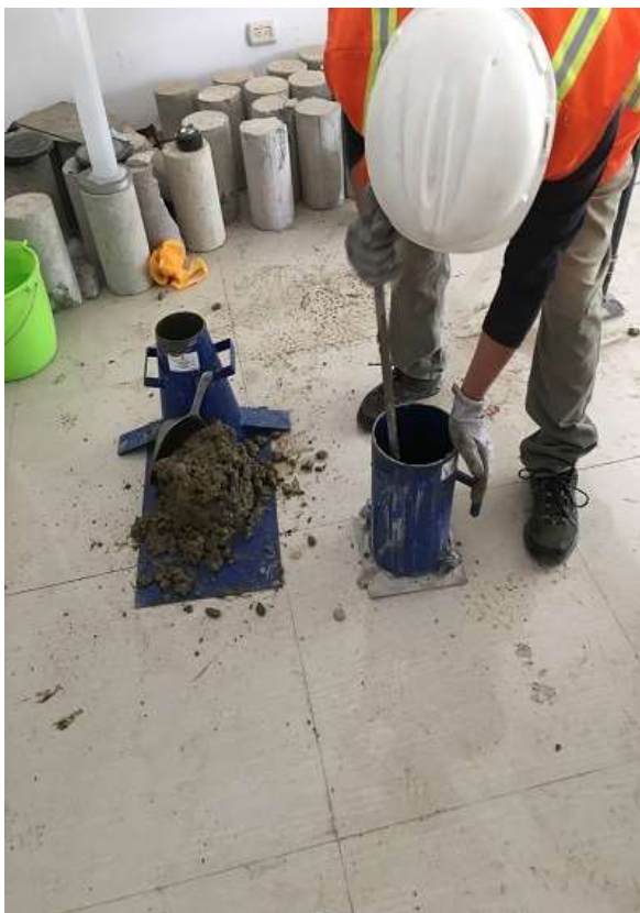
Fotografía N° 11. Elaboración de probetas.
