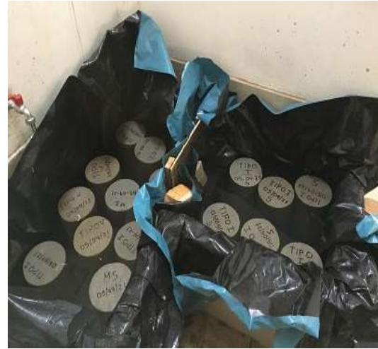
Fotografía N° 14. Curado de probetas de concreto
