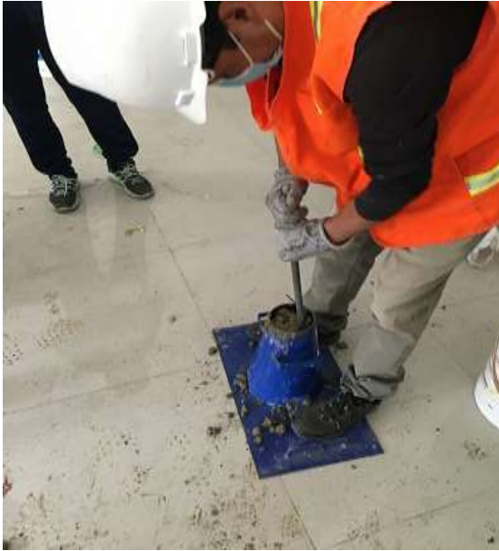
Fotografía N° 5. Prueba del Slump.
