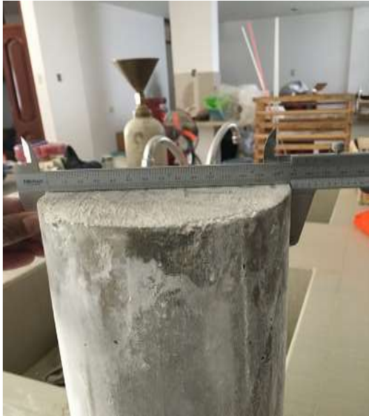
Fotografía N° 17. Midiendo el diámetro y altura de probetas para someterlos al ensayo a compresión.
