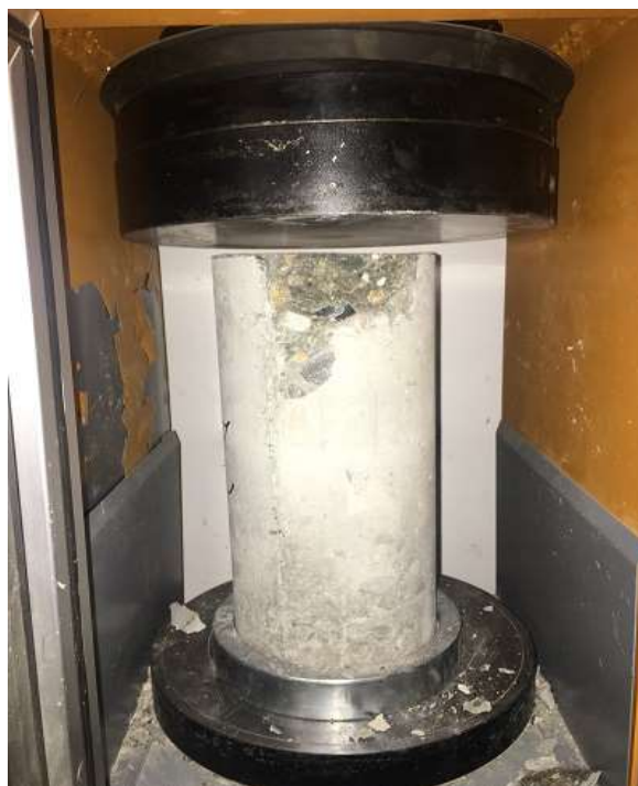
Fotografía N° 22. Falla tipo, fracturas en los lados de la parte superior o inferior. NTP 339.034
