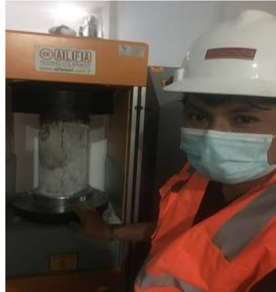
Fotografía N° 18. Realizando el ensayo a compresión de probetas de concreto.
