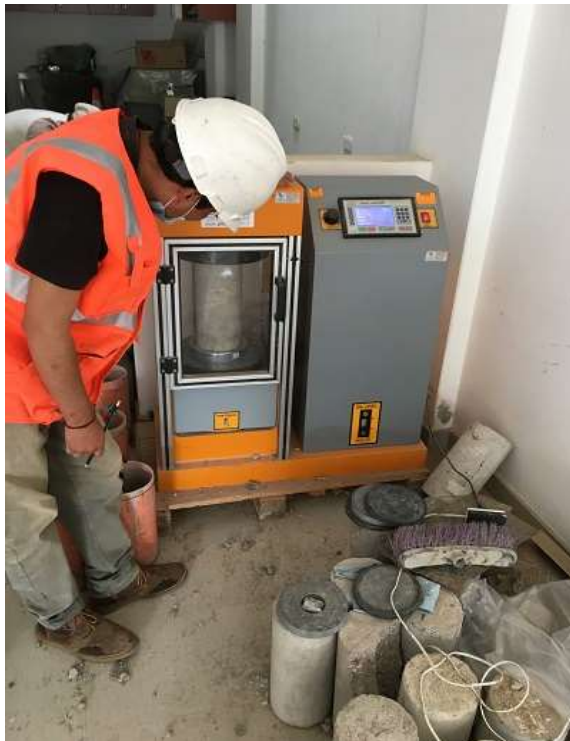
Fotografía N° 19. Realizando el ensayo a compresión de probetas de concreto
