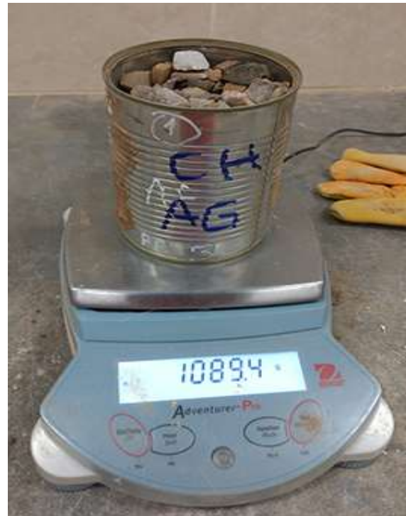
Fotografía N° 4. Pesando el agregado grueso para sacar el contenido de humedad del agregado de cantera de río.
