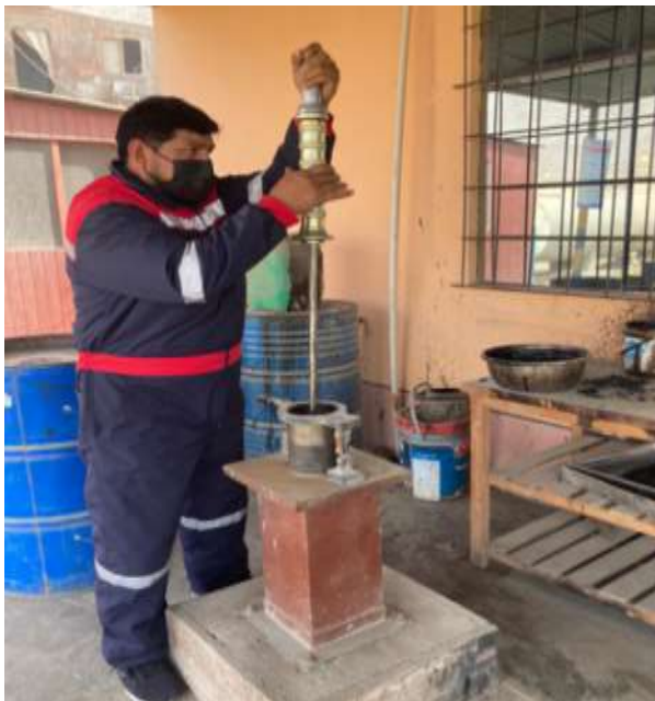
Figura 28 Realizando los 75 golpes de compactación para la probeta
