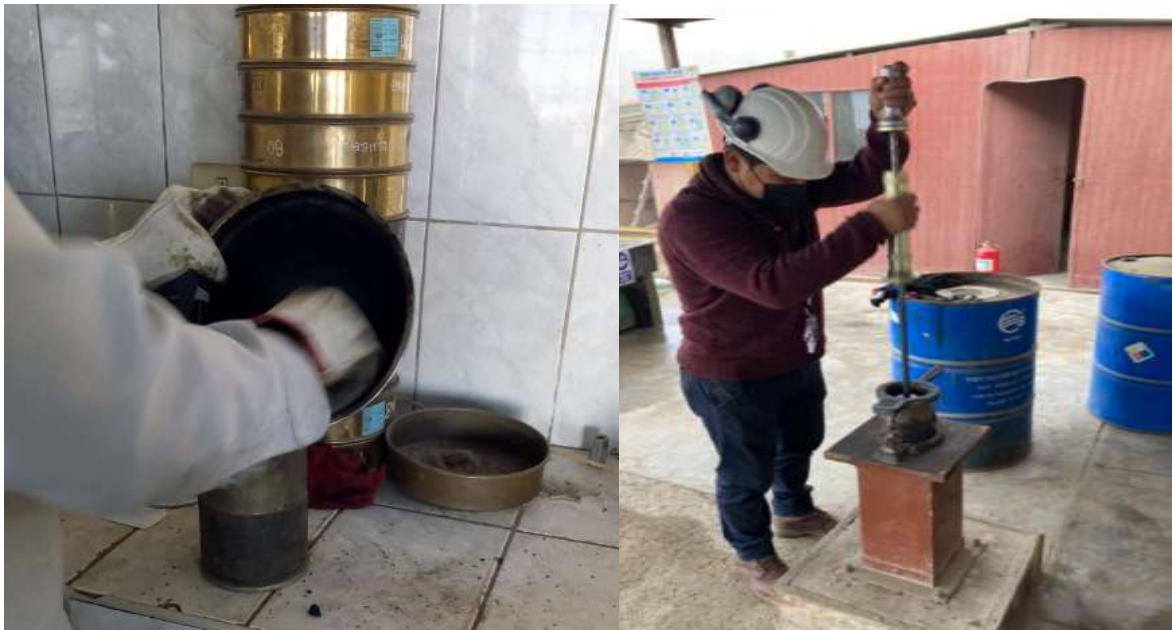
Figura 24. Llenado de mezcla para realizar probetas
