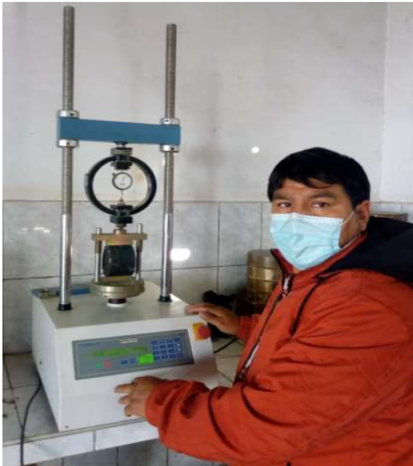
Figura 34. Prueba de rotura del ensayo LOTTMAN
