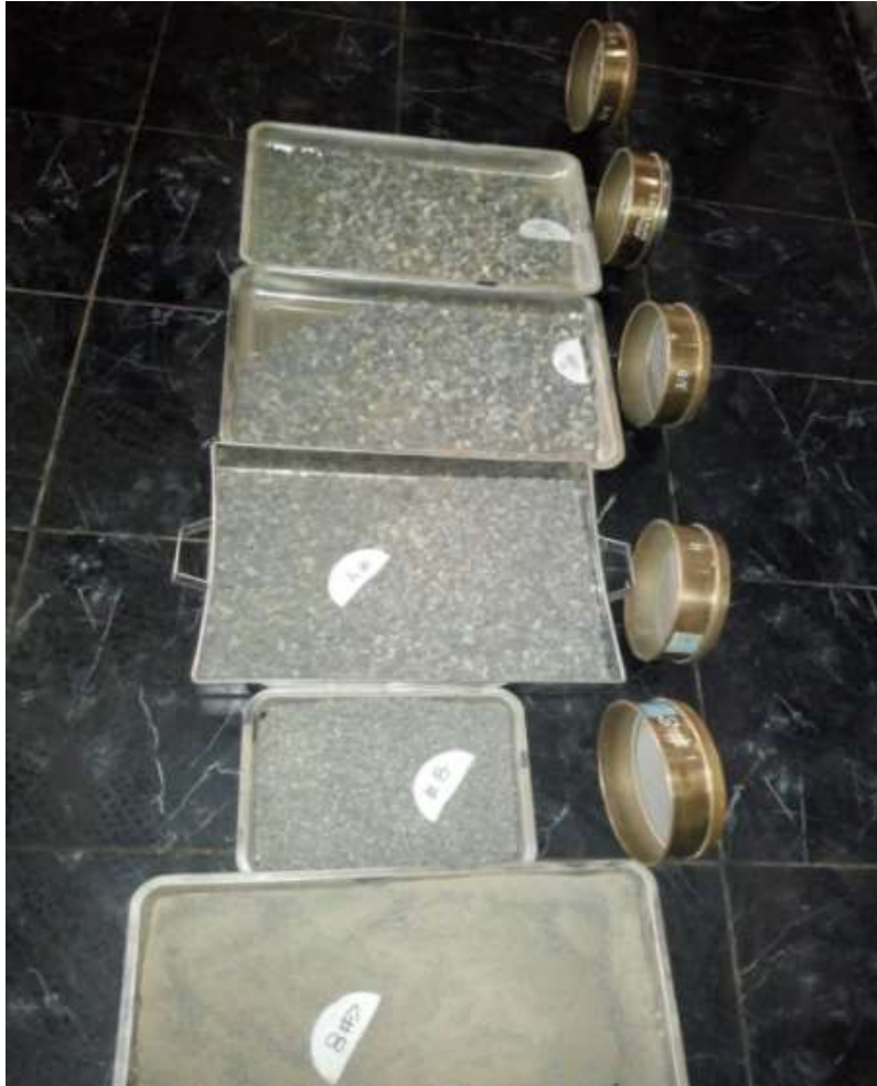
Figura 15. Muestras de los Agregados para el Análisis Granulométrico
