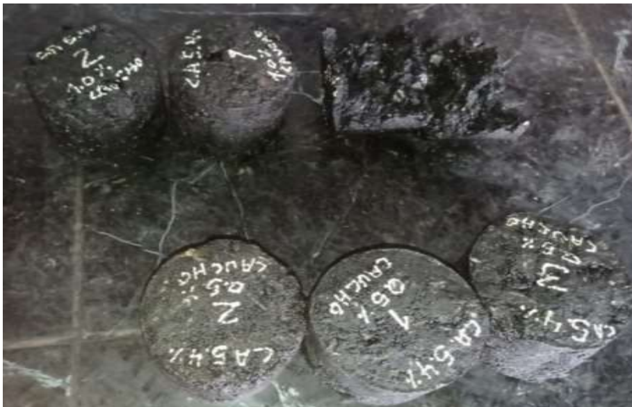
Figura 33- Se aprecia la rotura de las probetas
