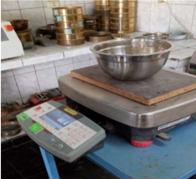
Figura 18. Pesado del acumulado 3/4" en una balanza electrónica
