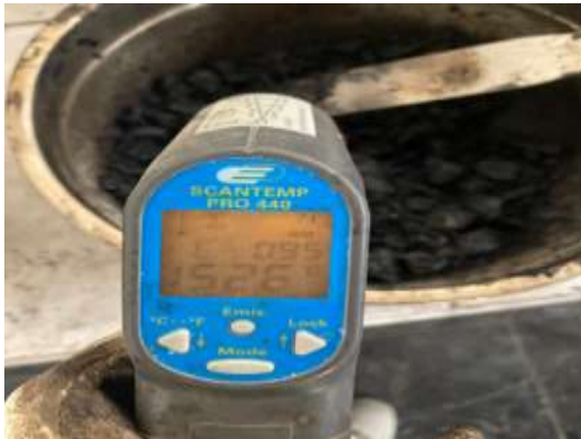
Figura 27. Se toma la temperatura de la muestra antes de llenar al molde
