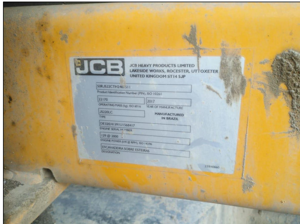
Figura 7. Características de la excavadora JCB.
