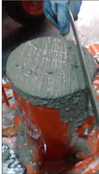
Figura 27: Elaboración de probetas de concreto con vidrio reciclado molido
