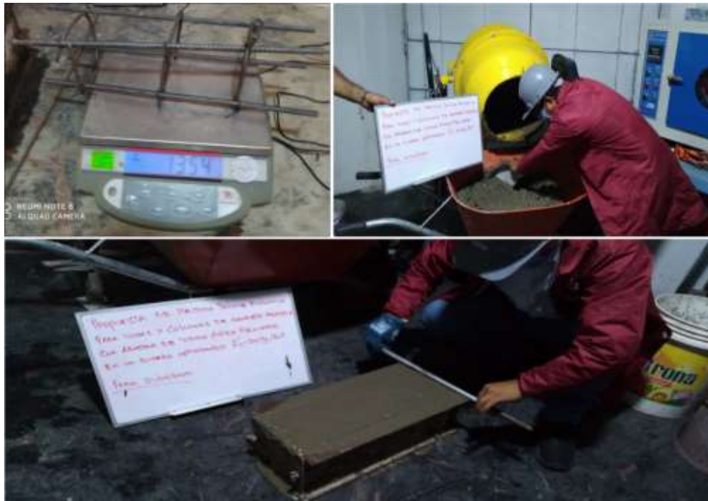
Figura 28: Elaboración de viguetas prismáticas armadas con adición de vidrio reciclado molido
