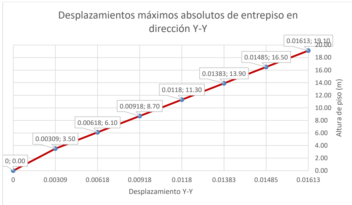
Figura 50 - Desplazamiento Absoluto por Nivel debido al Sismo Dinámico en Y, elaboración propia
