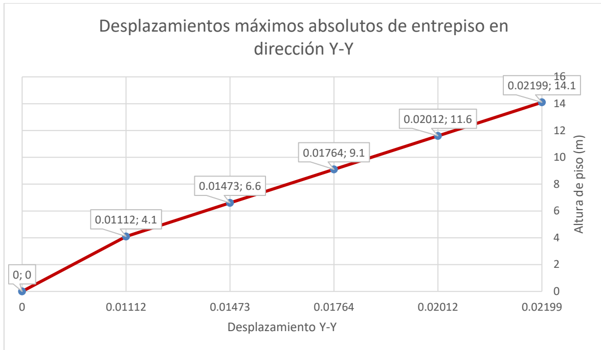
Figura 70 - Desplazamiento Absoluto por Nivel debido al Sismo Dinámico en Y, elaboración propia
