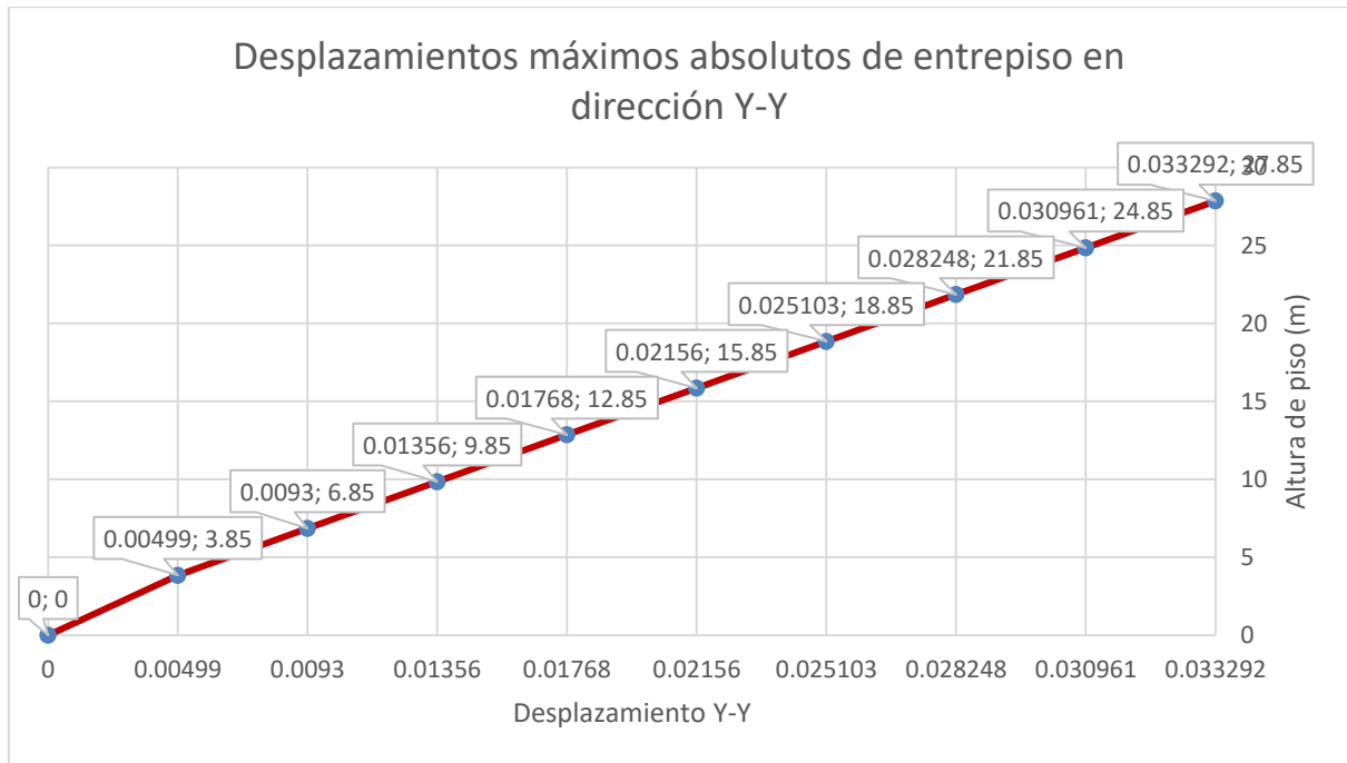
Figura 90 - Desplazamiento Absoluto por Nivel debido al Sismo Dinámico en Y, elaboración propia
