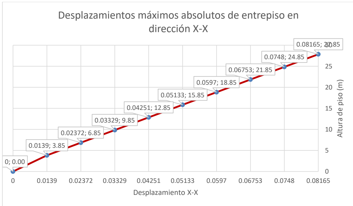
Figura 103 - Desplazamiento Absoluto por Nivel debido al Sismo Dinámico en X, elaboración propia
