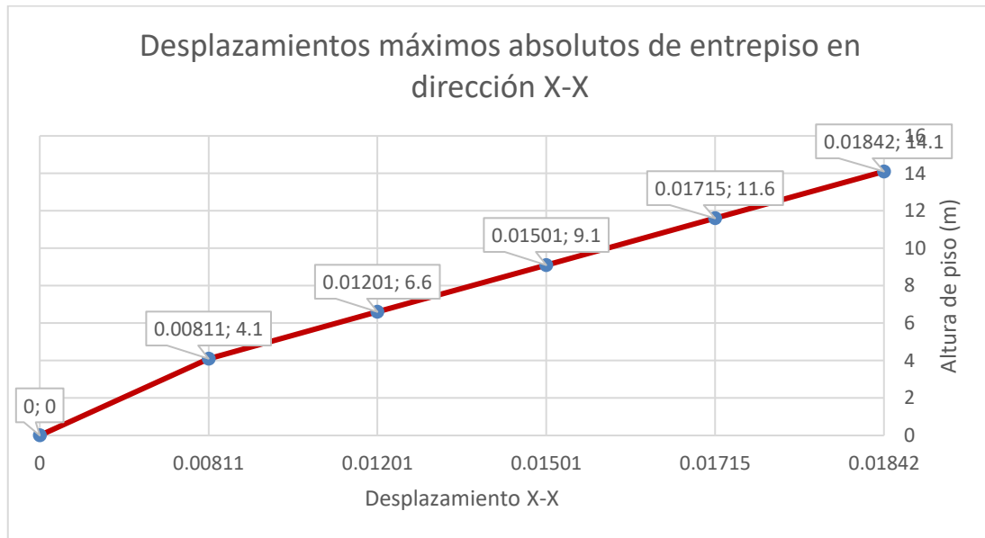
Figura 67 - Desplazamiento Absoluto por Nivel debido al Sismo Dinámico en X, elaboración propia
