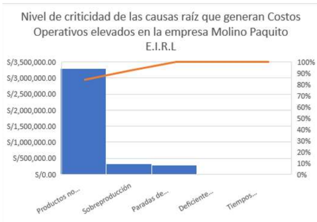
Figura 3 Diagrama de Pareto de la empresa Molino Paquito E.I.R.L
