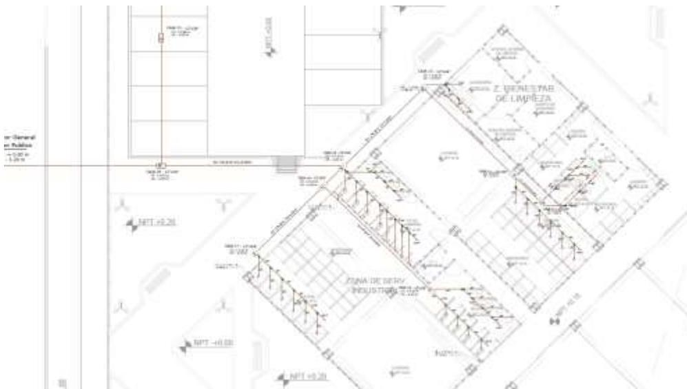
Imagen 02: Conexión de redes de desagüe interior a colector General
