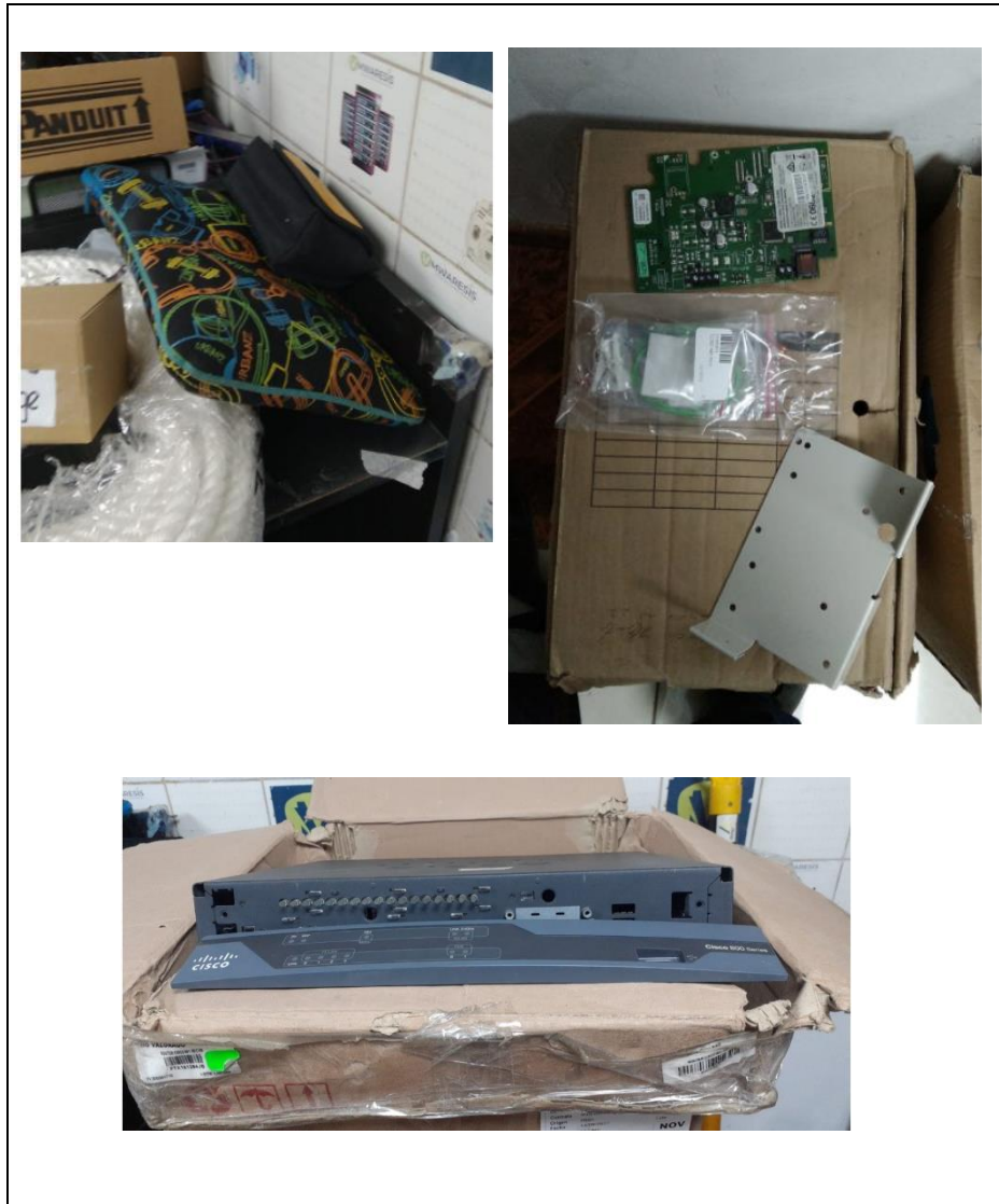
Figura 9: Deterioro de equipos por incorrecto almacenamiento
