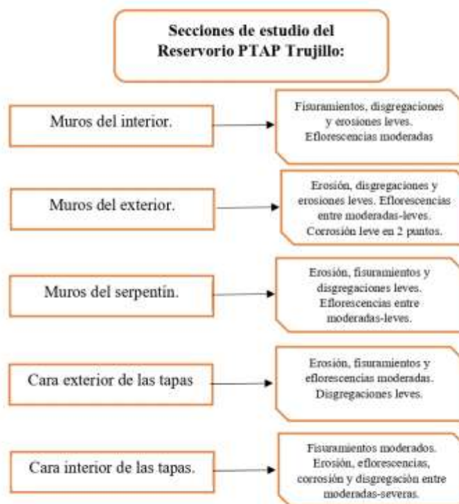
Figura 1. Seccionamiento de la estructura y estado patológico.
