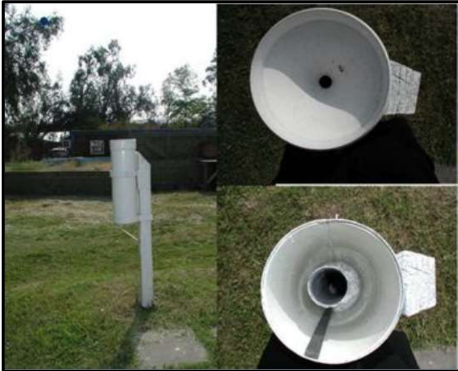
Figura 02: Pluviómetro Simple Estandarizado. A la Izquierda Vista General. Arriba Derecha, Vista desde Arriba. A la Derecha Abajo, Vista del Interior, con el Recipiente de Acumulación y la Regla de Medida.
