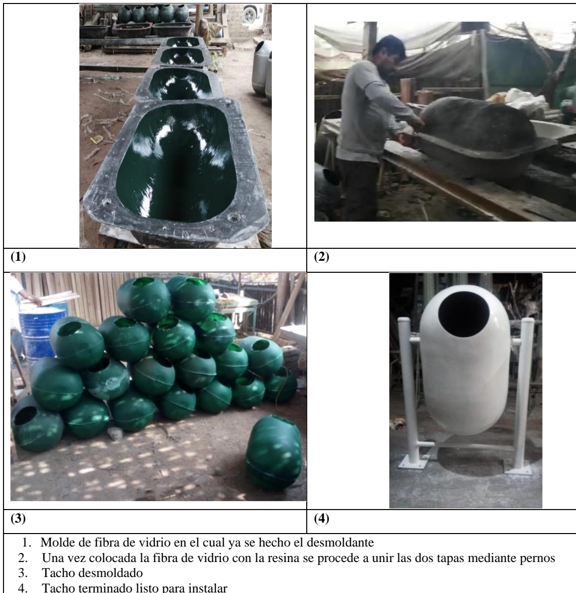
Figura 164. Proceso de fabricación de tachos de fibra de vidrio.
