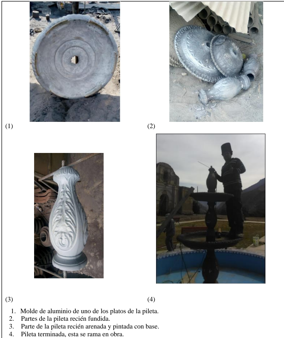
Figura 172. Proceso de fabricación pileta de hierro fundido.
