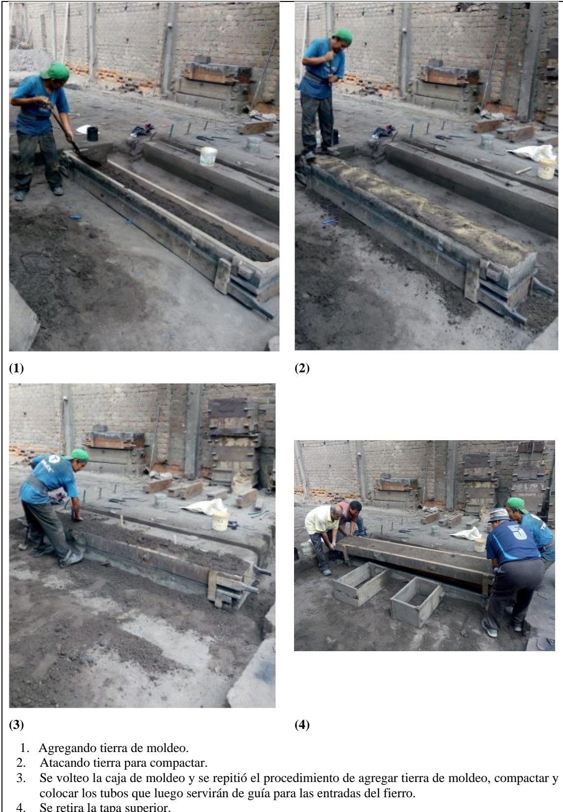
Figura 166. Proceso de fabricación de postes de fierro fundido 2.
