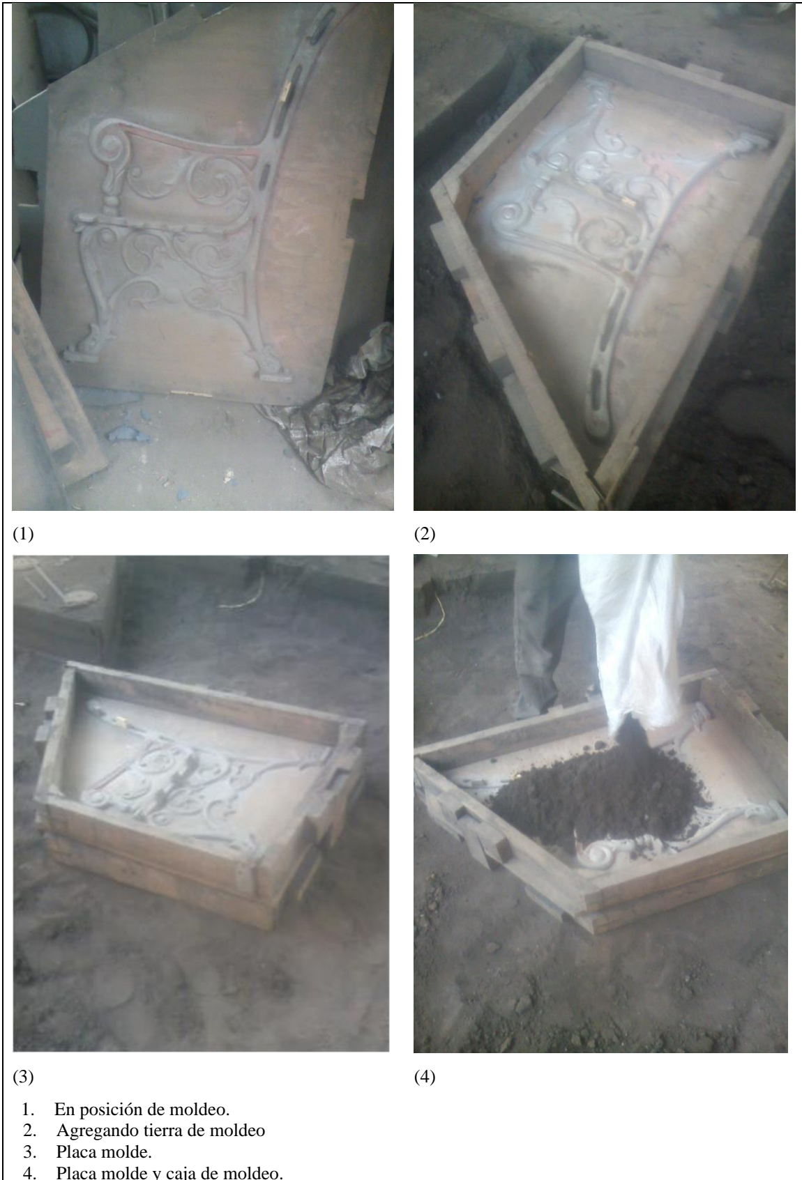
Figura 157. Proceso de fabricación de bancas de hierro fundido 1.
