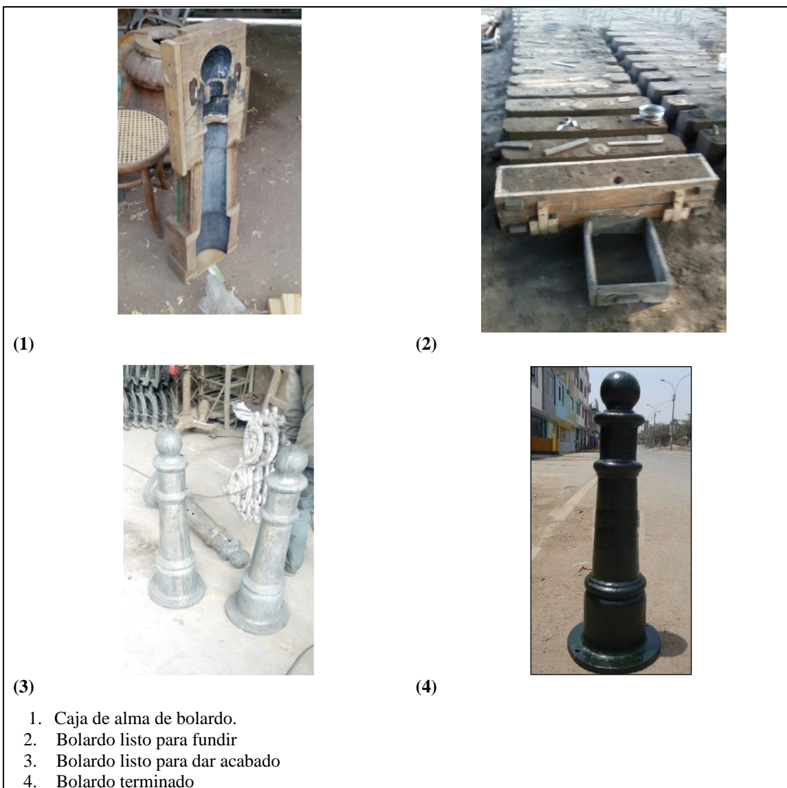
Figura 169. Proceso de fabricación de bolardos de fierro fundido.
