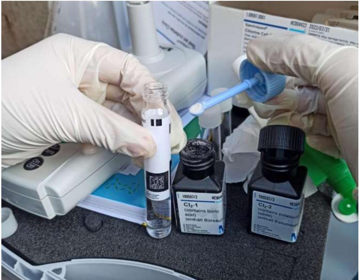
ANEXO n.º 16. Reacción de la muestra con el reactivo Cl<sub>2</sub>-1 (ácido bórico).
