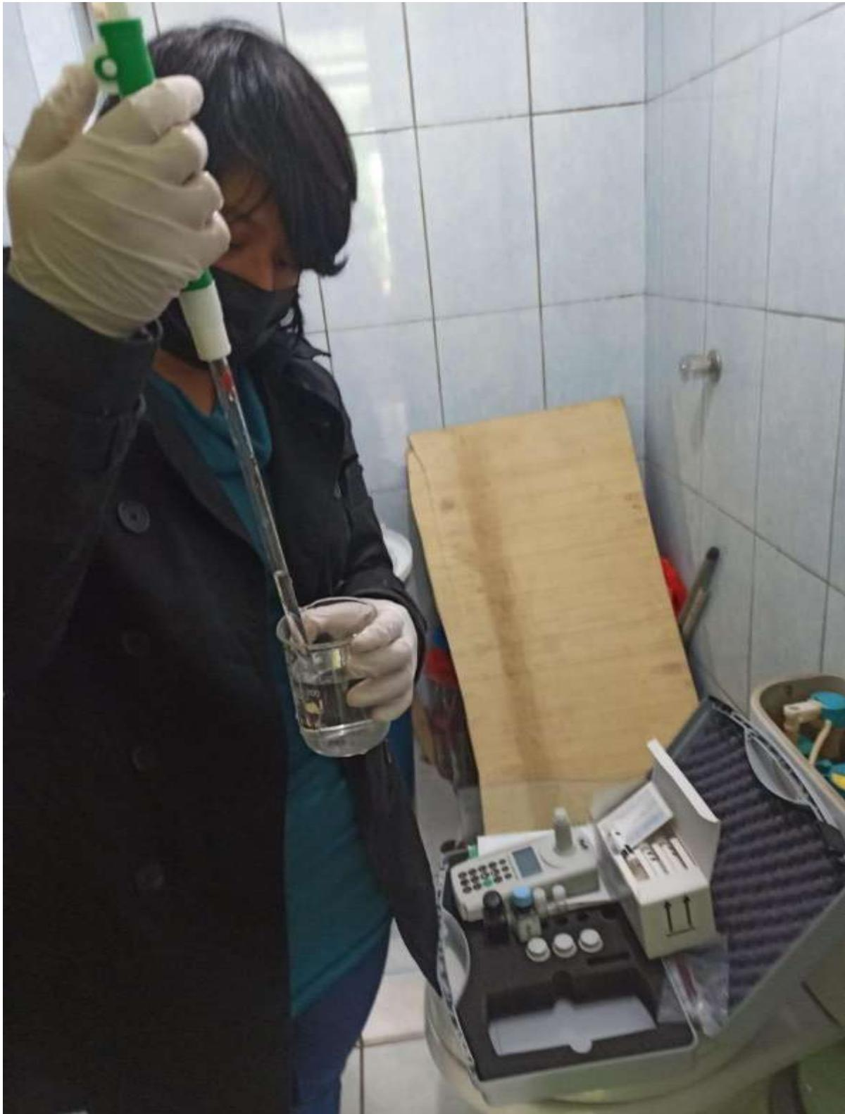
ANEXO n.º 15. Agregado del reactivo  $\text{Cl}_2-1$  (ácido bórico) en la muestra.
