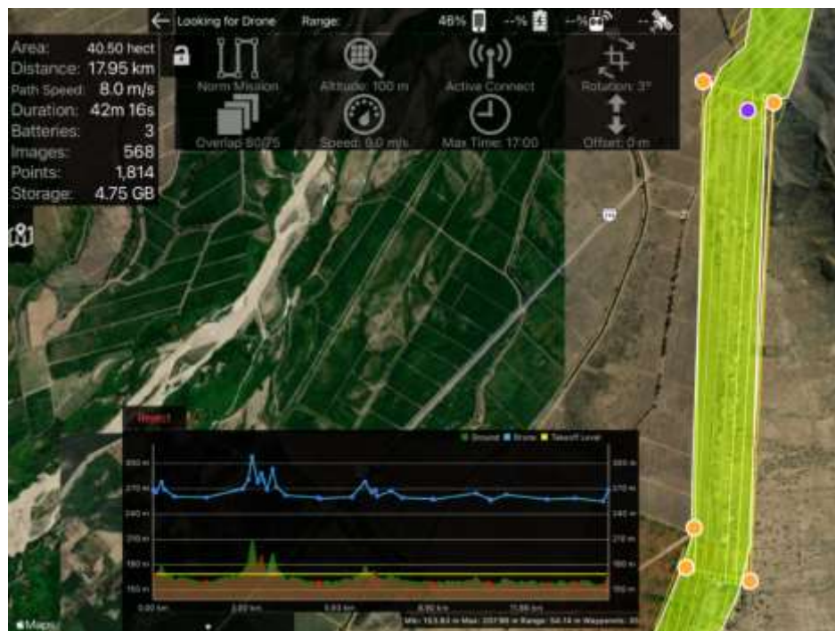
Figura 20. Plan de vuelo N° 7, mostrando la altimetría.
