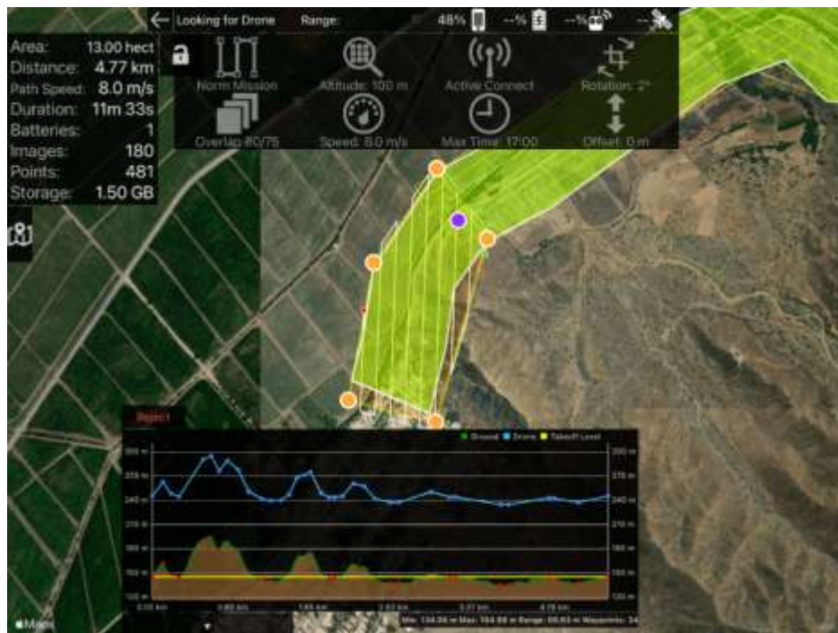
Figura 18. Plan de vuelo N° 1, mostrando la altimetría.
