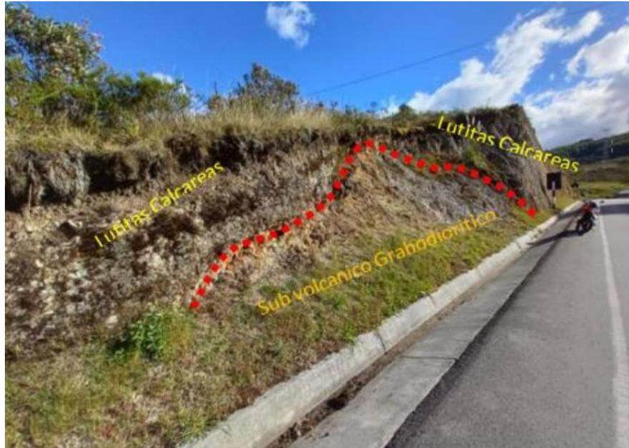
*Figura 64. Contacto ente subvolcánico granodiorítico y lutitas calcáreas.*
