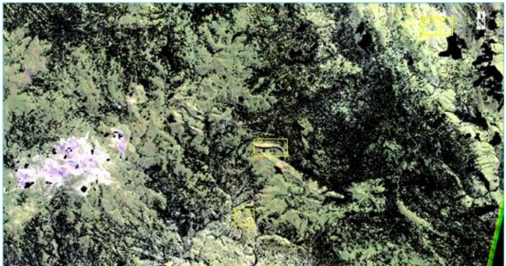
*Figura 25. Combinación de bandas RGB 531, muestra presencia de arcillas (verde claro).*
