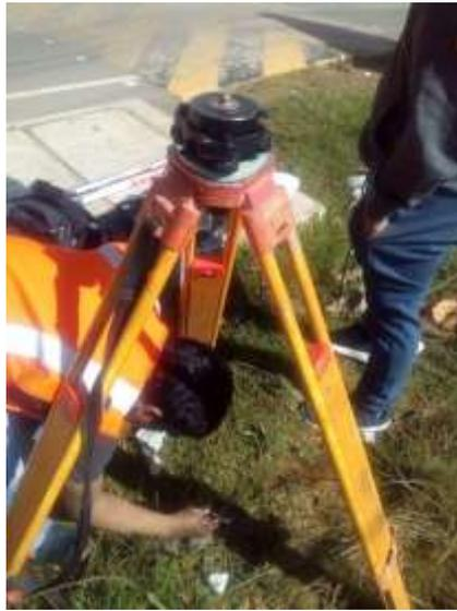
*Figura N° 44.* Posicionamiento de base de GPS diferencial.
