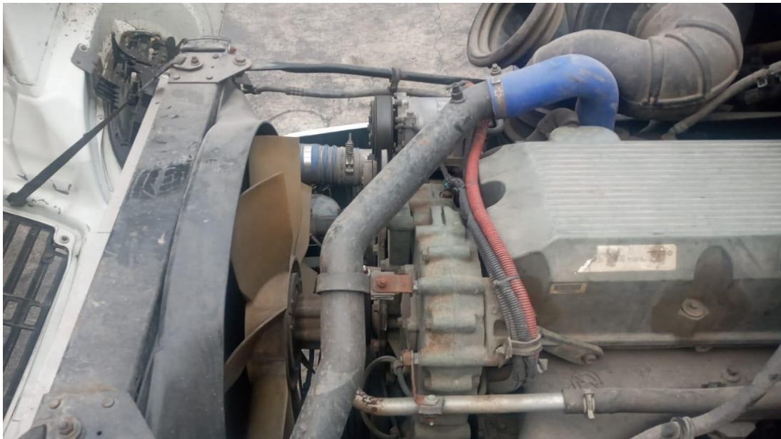
Figura 11. Sistema de refrigeración. Fuente: Propia del autor, 2021.
