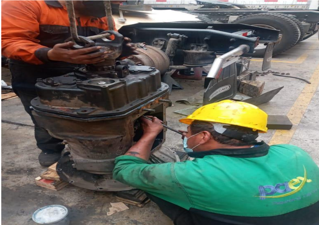
Figura 13. Mantenimiento correctivo, caja de cambios. Fuente: Propia del autor, 2021.
