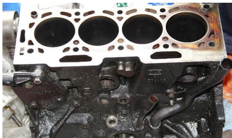
Figura 7. Bloque de un motor de 4 cilindros. Fuente: López, 2012.
