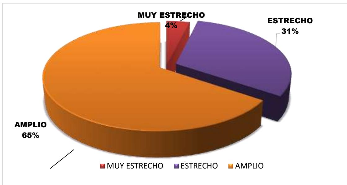
En la Figura 21 se muestra la separación de la Patología Fisura, presenta 4% de separación muy estrecho con una abertura de 0- 0.5 mm, 31% de separación estrecho con una abertura de 0,5 - 1.5 mm, 65% de separación amplio con una abertura de 1,5 – 5,0 mm.
