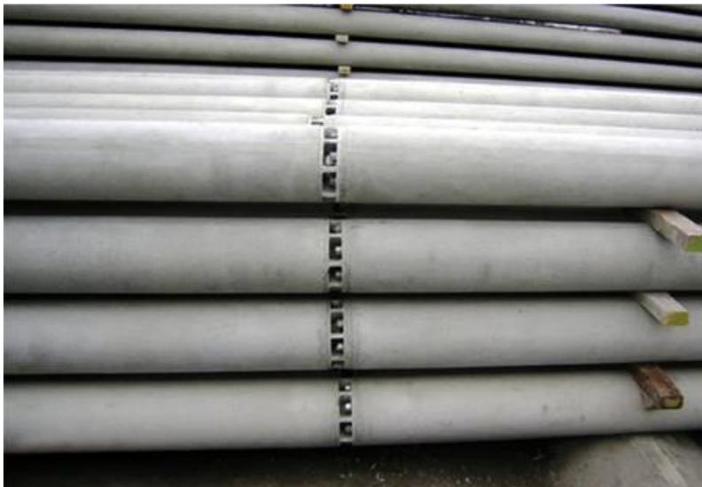
*Figura 4 Postes de concreto armado centrifugado seccionado*
