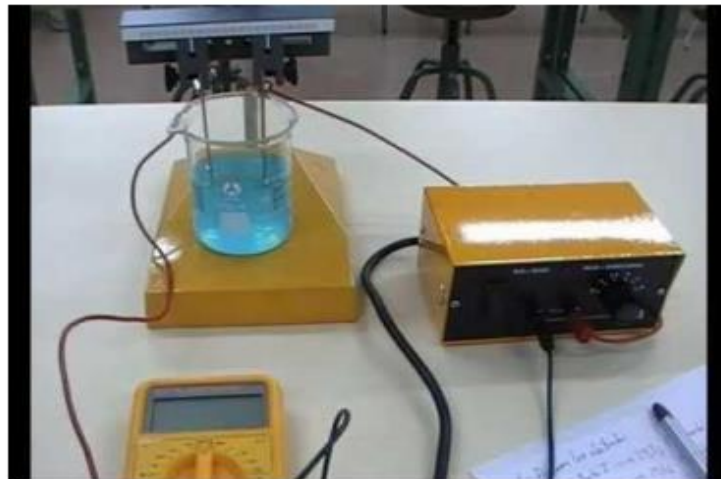
Figura 3. Sistema experimental de electrólisis
