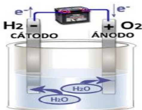
Figura 1. Método donde se basa el tratamiento de las aguas ácidas
