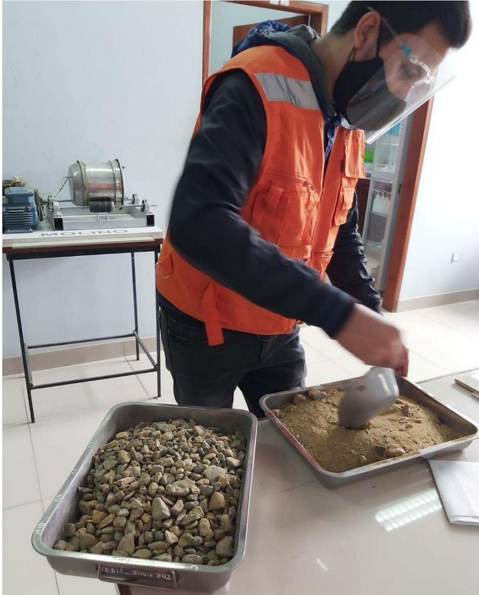
**Anexo N° 06:** *Ensayo de Granulometría del agregado grueso*
