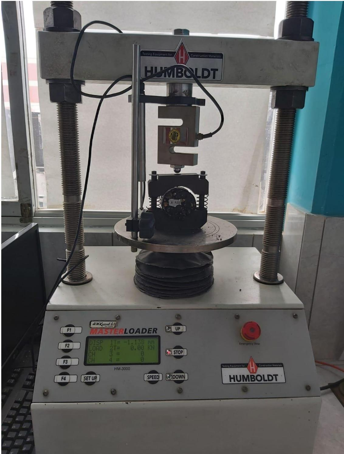
**Anexo N° 13:** *Briquetas asfálticas con PET ensayas por Marshall*
