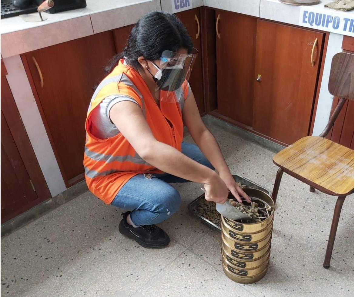
**Anexo N° 07:** *Ensayo de Granulometría del agregado fino*
