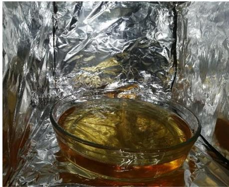
Se lleva la capsula pírex a la caja cerrada de papel aluminio y se expone a la radiación ultravioleta mediante la lámpara.
