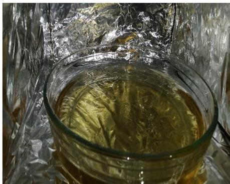
Se toma la muestra N°1 después de 3 horas de interacción, una cantidad inicial de 50 ml en un frasco sellado para enviar al laboratorio.
