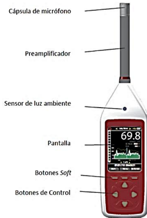
Figura N°1. Componentes de un sonómetro
