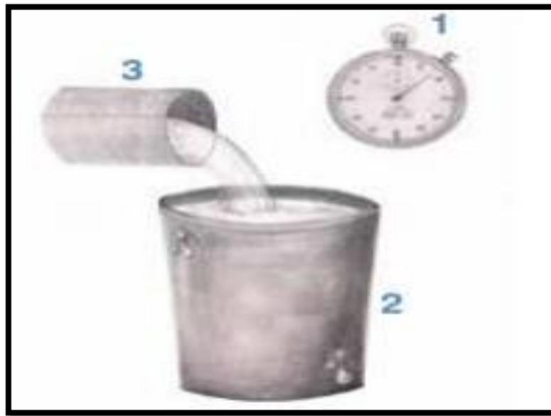
Figura 1. Materiales utilizados para medición del caudal con el método volumétrico.
