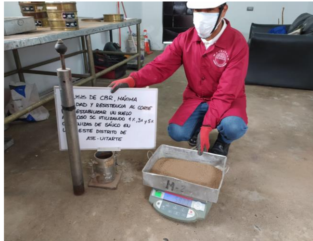
Figura 23: Agregado para el CBR
