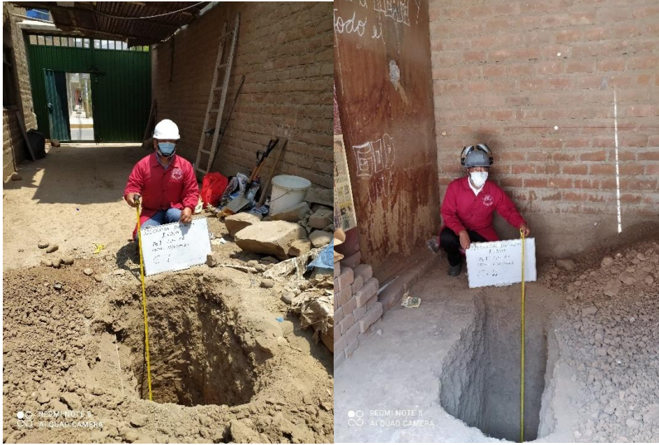
Figura 16: Calicatas Fuente: Elaboración Propia
